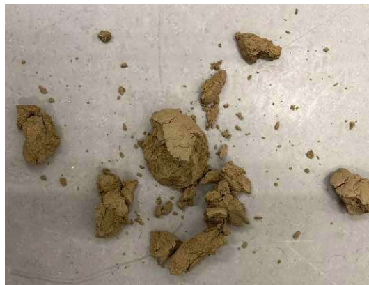
Abb. 5.05 | Probe P8 nach der Kugelfallprobe
