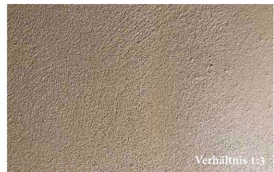
Abb. 5.72 | Einfluss verschiedener Verhältnisse des Grobkornanteils in Lehmputz (Lehm: Sand)
