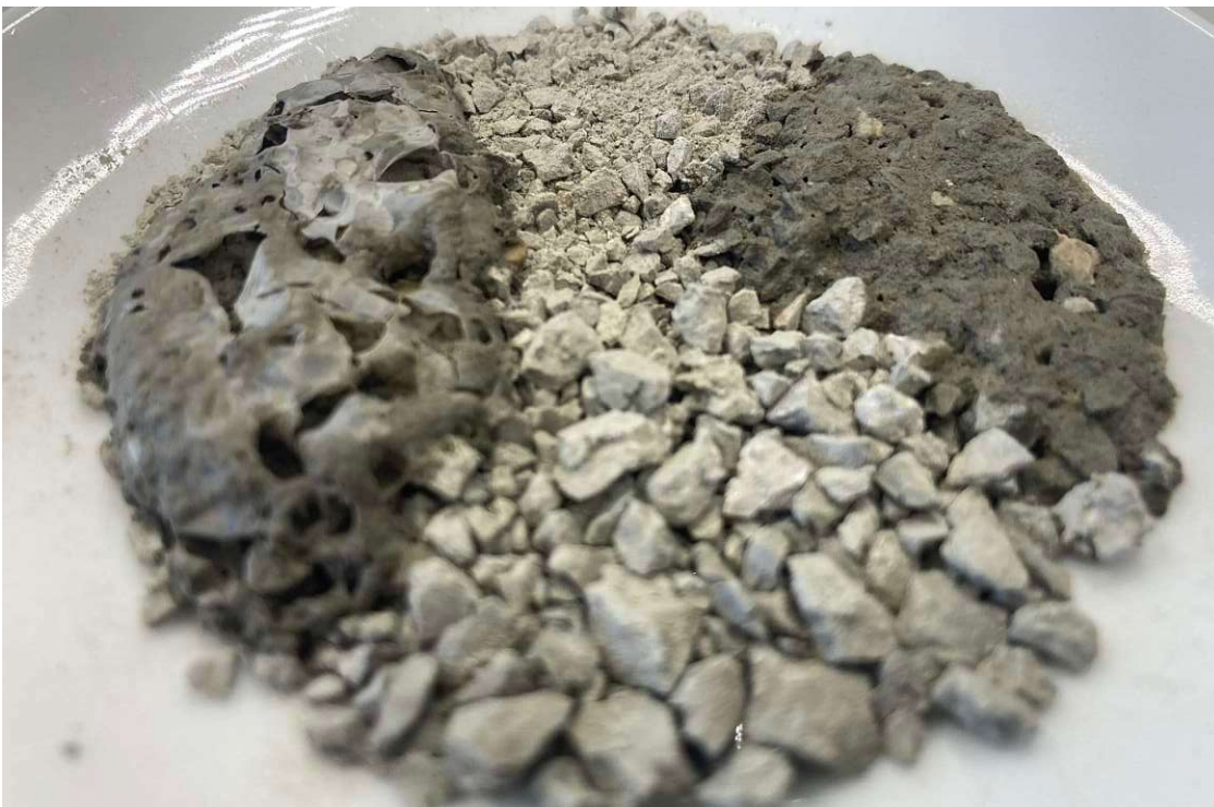
Abb. 5.30 | Vergleich der Säurereaktion, links: Salzsäure, rechts: Essigsäure
