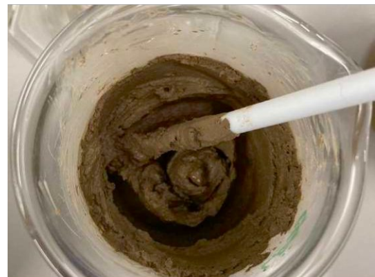
Abb. 5.129 | Plastischer Zustand von Löss (100 mg) mit 30 ml Wasser
