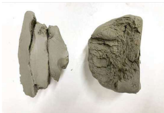
Abb. 5.51 | Unterschied von gehämmerter und aufgeschlagener Probe
