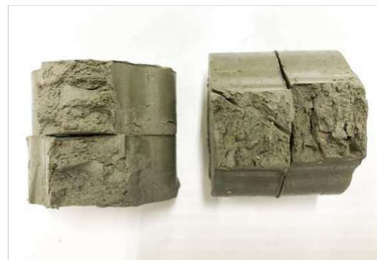
Abb. 5.52 | Links: Ausrichtung der Tonminerale im Mittelteil senkrecht zur Bruchstelle | Rechts: Regelmäßige Ausrichtung der Tonminerale
