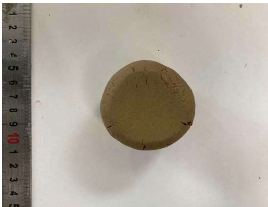
Abb. 5.04 | Probe P5 nach der Kugelfallprobe
