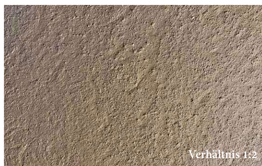
Abb. 5.72 | Einfluss verschiedener Verhältnisse des Grobkornanteils in Lehmputz (Lehm: Sand)
