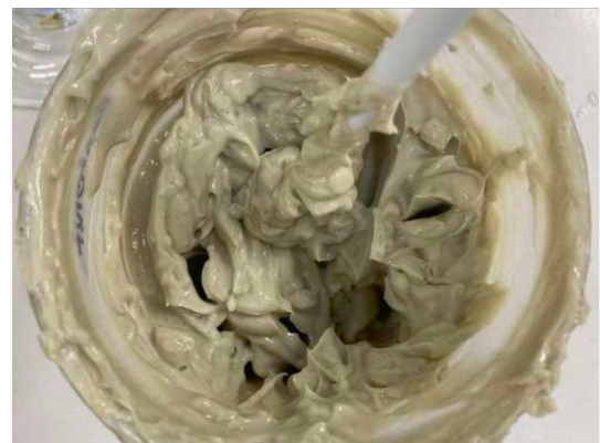
Abb. 5.131 | Plastischer Zustand von Bentonit (100 mg) mit 400 ml Wasser
