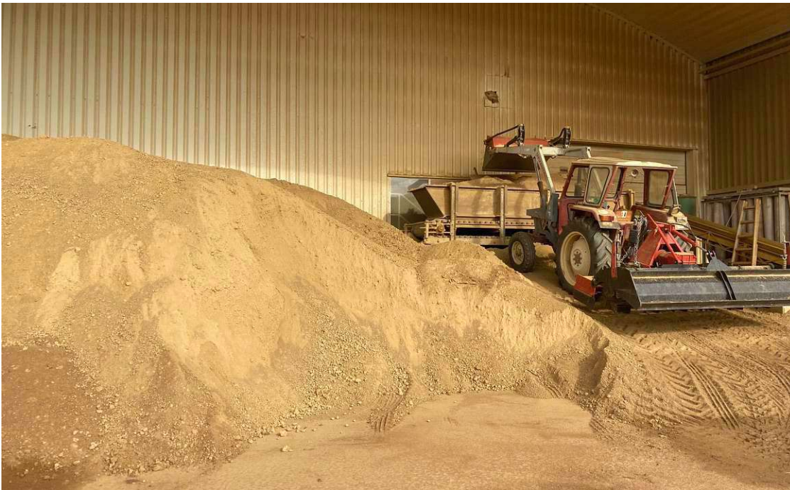
Abb. 3.18 | Zuführung von luftgetrocknetem Material in den Beschicker (pro Lehm)
