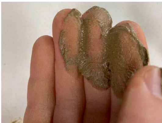
Abb. 5.09 | Sandiges, schluffiger Lehm von Probe P8
