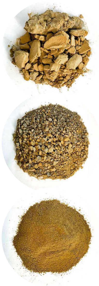
Abb. 5.44 | Aufbereitungsschritte: Luftgetrockneter Zustand, Zerkleinerung, Siebung
