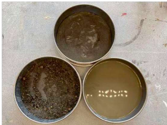
Abb. 5.78 | Siebrückstände (5 mm und 63 \mu\text{m} ) und Siebdurchgang (Anteil)
