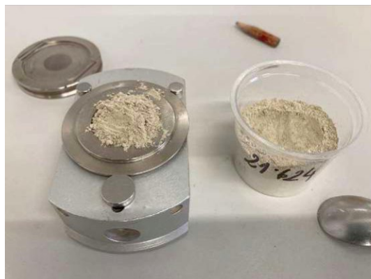
Abb. 5.112 | Probeträger mit pulverisierter Probe
