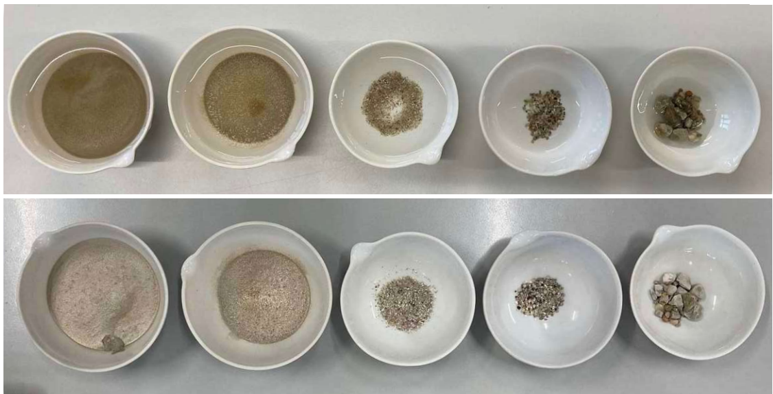
Abb. 5.93 | Siebrückstände vor und nach der Trocknung
