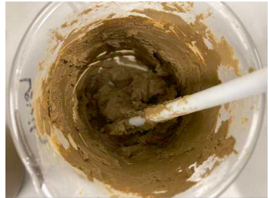
Abb. 5.130 | Plastischer Zustand von Lehmputz (100 mg) bei 25 ml Wasser
