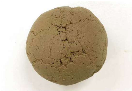
Abb. 5.53 | Linienbildung bei Kugelformung
