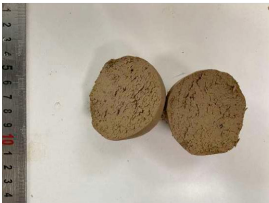
Abb. 5.07 | Stumpfe Schnittfläche von Probe P8
