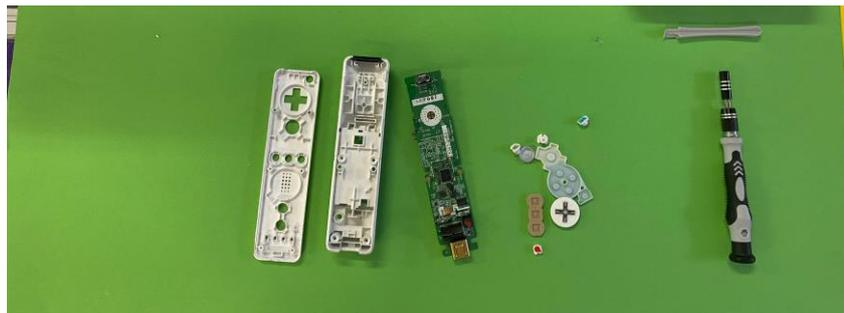
Abbildung 30: Arbeitsbereich zur zerstörungsfreien Demontage
