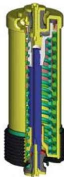
Abbildung 1.8: Schnitt durch einen Betätigungszyylinder [4]
