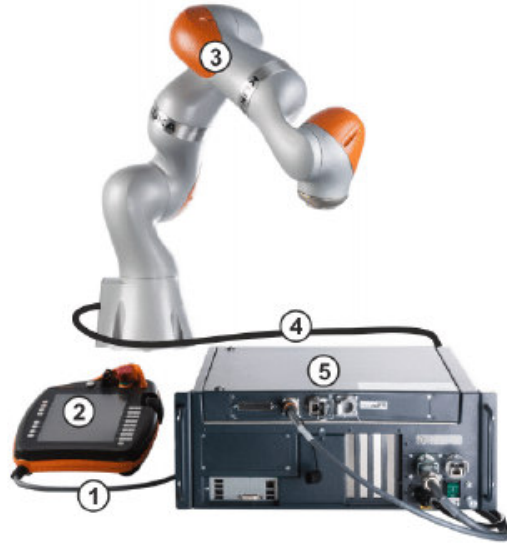
Abbildung 3.11.: Übersicht Robotersystem, (2) Handbediengerät (KUKA Smart-PAD), (3) Roboter KUKA iiwa, (5) Robotersteuerung (KUKA Sunrise Cabinet) [19]
