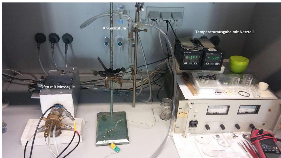
Abbildung 3: Aufbau der HT-CV Messvorrichtung
