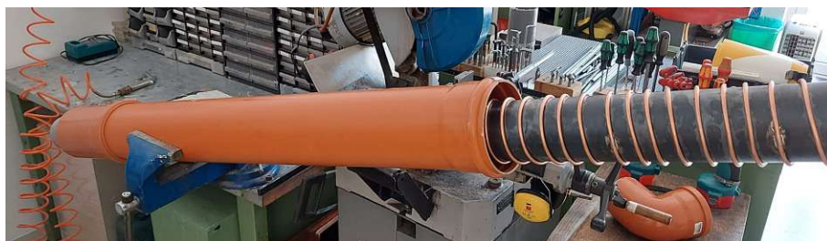
Abbildung 3.19: Einführung der Kühlspirale im Wärmetauscher (Versuchsaufbau 4).
