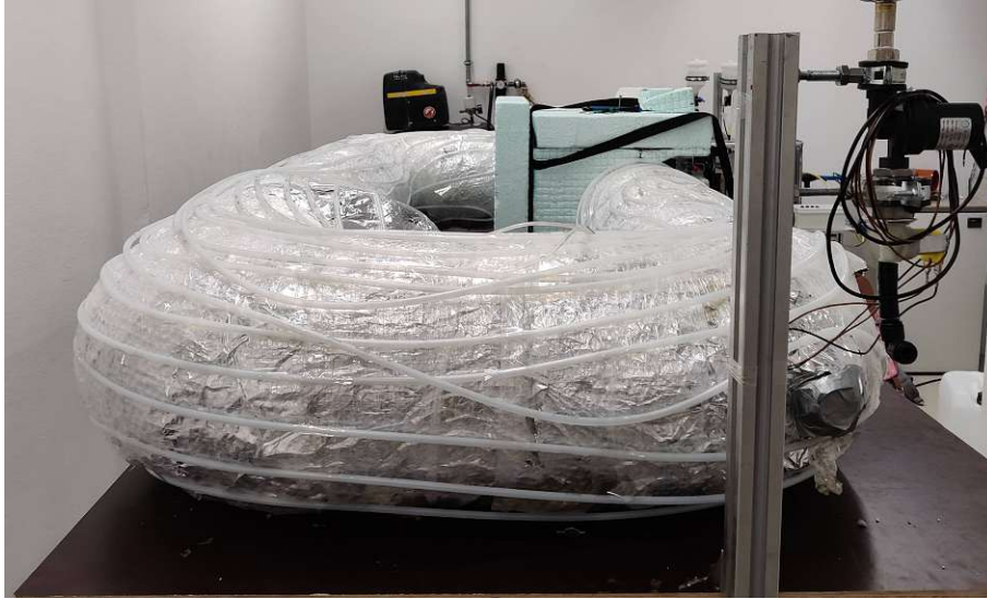
Abbildung 3.20: Versuchsaufbau 4 ohne der äußersten Dämmschicht und mit dem PVC-Pneumatikschlauch für die Wasserkühlung.
