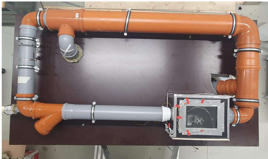
Abbildung 3.12: Draufsicht des Klima-Windkanals (Versuchsaufbau 2) ohne Dämmung.
