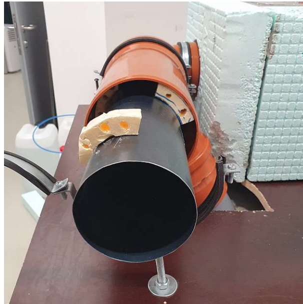
Abbildung 3.14: Versuchsaufbau 3 mit Stahlrohr im Wärmetauscher zur Verbesserung des Wärmeübergangs.
