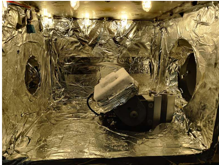
Abbildung 3.17: Innenansicht der Testsektion (Versuchsaufbau 3). Probenhalterung mit Bildung von Raureif aufgrund der eingeschalteten Probenkühlung.
