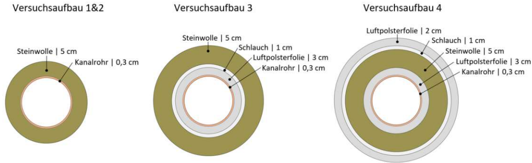
Abbildung 3.18: Schematische Darstellung der Dämmschichten von Versuchsaufbau 1 bis 4
