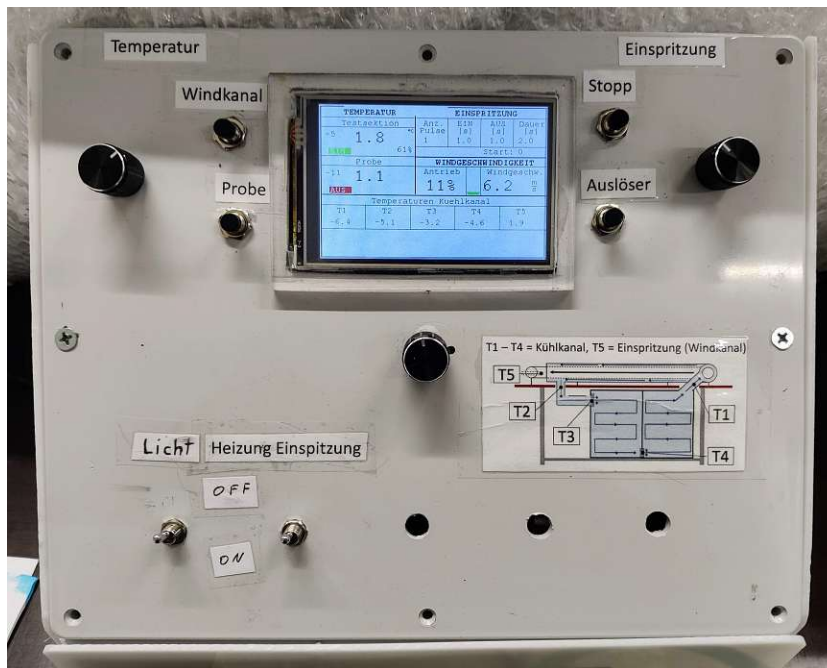
Abbildung 3.29: Gehäusekasten der Steuerung von außen mit den Ein- und Ausgabeelementen.
