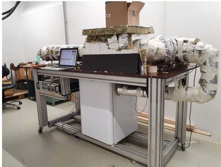
Abbildung 3.9: Versuchsaufbau 1 mit Kühlanlage und provisorisch angebrachten Steinwollmatten.
