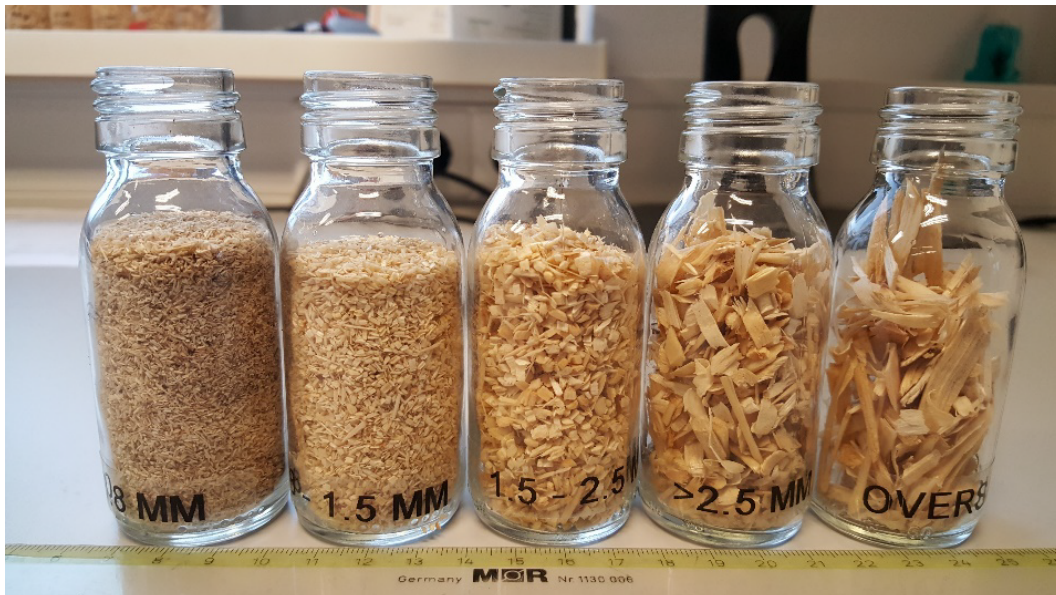
Abbildung 3.2: Als Ausgangsmaterial für die Herstellung des verwendeten Pyrolyseöls durch BTG-BTL dienen Kieferholzspäne. Im Bild Fraktionen aus einer Siebanalyse durch den Hersteller [30].
