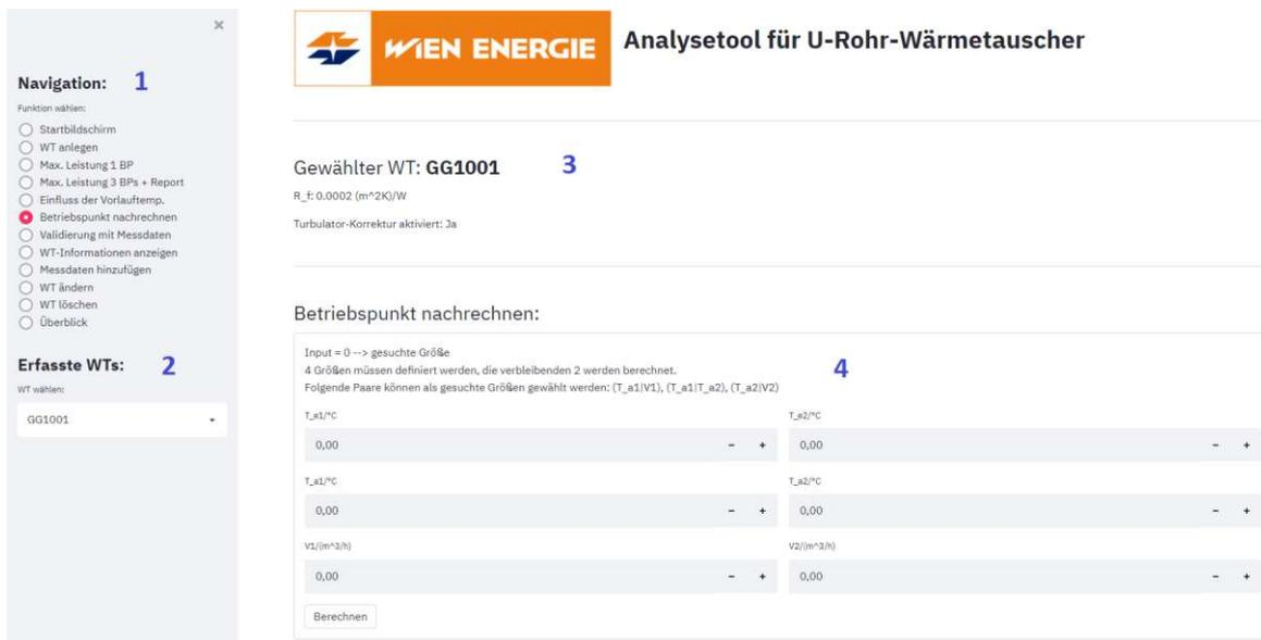
Abbildung 24: Grafische Benutzeroberfläche der erstellten Web-App. In der Sidebar werden die Funktion (1) und das WT-Objekt (2) ausgewählt. Im Hauptfenster werden oben Informationen zum aktiven WT-Objekt angezeigt (3). Darunter befindet sich das Eingabefeld (4), in das die Input-Daten für die selektierte Funktion einzugeben sind.
