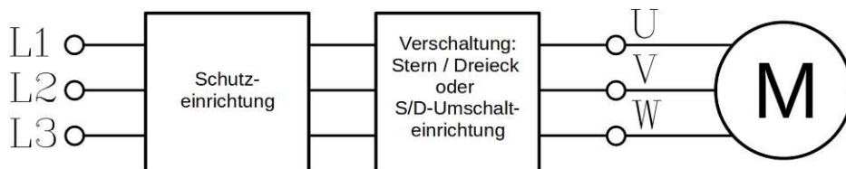
Abbildung 6.7: Schema einer direkt am Netz angeschlossenen Asynchronmaschine
