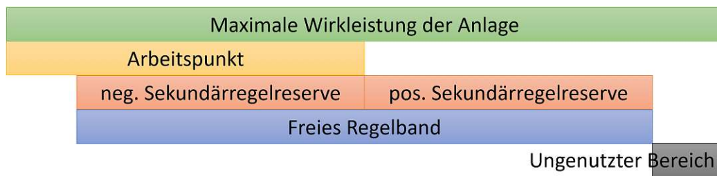
Abbildung 3.5: Arbeitspunkt Sekundärregelreserve nach [APG, 2015a]
