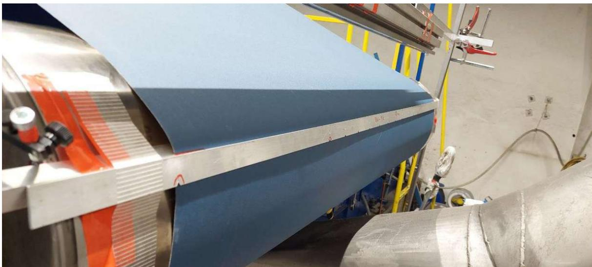
Abb. 9: Montierte Schablone zur Positionierung des Alicona Edgemaster
