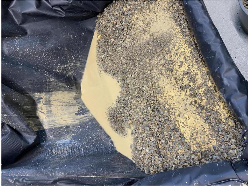
*Abbildung 36: Wasseransammlung am feuchten Versuchsaufbau*
