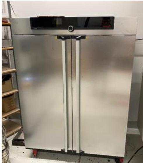
*Abbildung 33: Verwendeter Trockenschrank*
