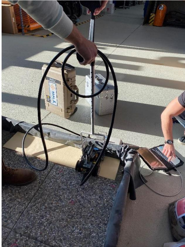
*Abbildung 43: Weggesteuerter Versuch mittels Georadar*
