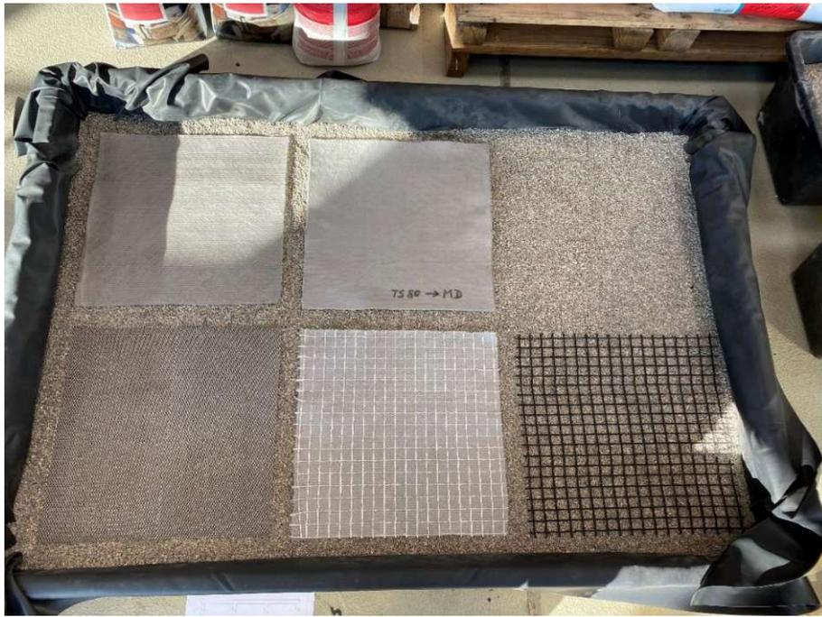
Abbildung 28: Beispiel einer der getesteten von Materialanordnung oberhalb der Bettung
