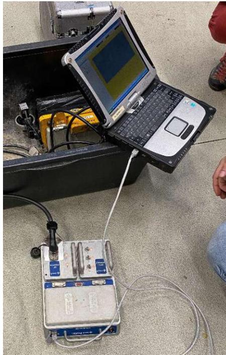
*Abbildung 32: Datenerfassung während der Versuche mittels Laptops mit Aufnahmesoftware und Control Unit*
