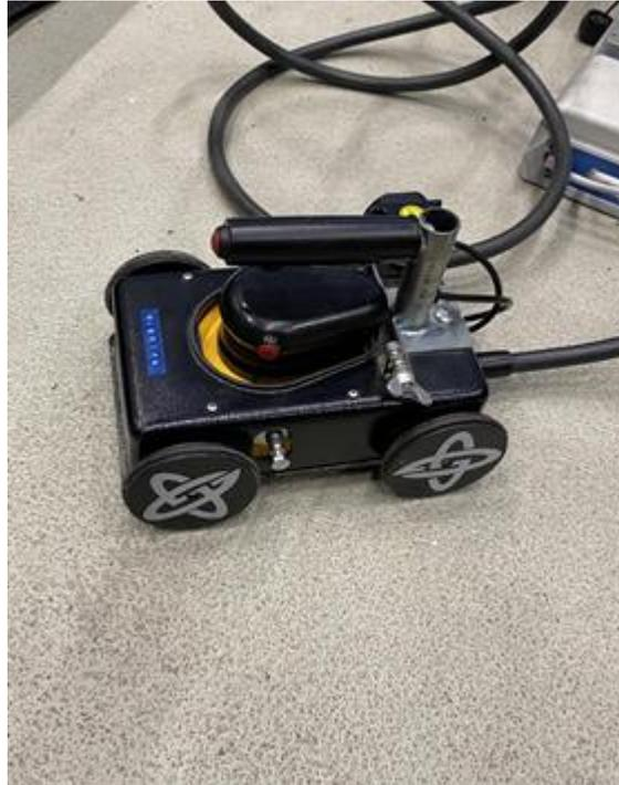
*Abbildung 30: Für die Versuche verwendetes Georadar*
