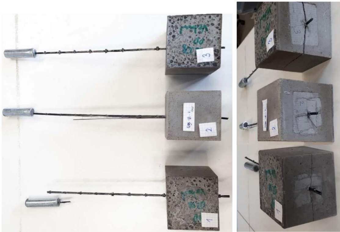
Abb. 8-42: Übersicht der Versagensursachen der Versuchskörper
