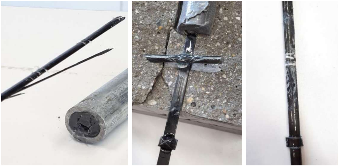
Abb. 8-50: Bruchstelle an der Einspannstelle (links); abgescherte Rückseite (mittig) und Vorderseite (rechts) des Prüfrovings
