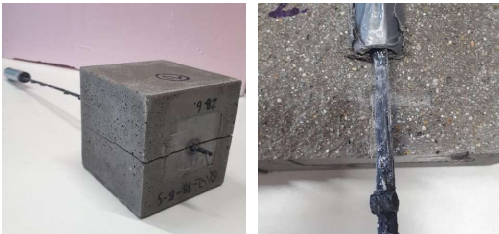
Abb. 8-35: Spaltriss am Probekörper (links); abgescherter Prüfrovig (rechts)
