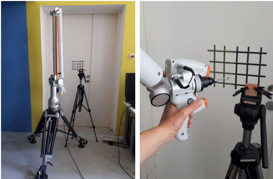
Abb. 4-2: Laserscanner mit Messarm (links); Handstück (rechts)
