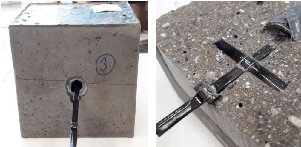
Abb. 8-45: Spaltriss am Probekörper (links); abgescherter Roving (rechts)
