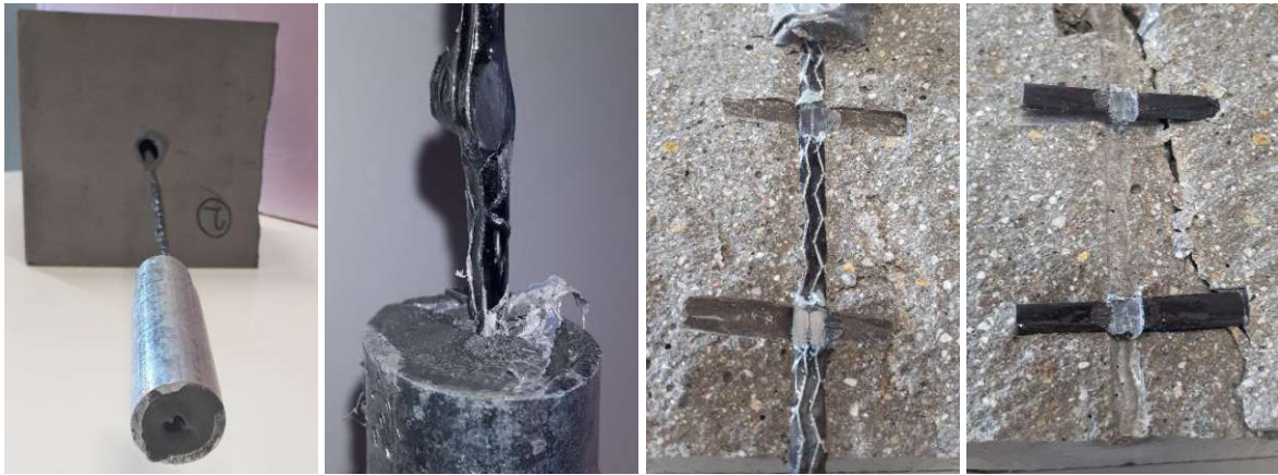
Abb. 8-20: Schlupf im Einspannrohr; Abscherung des geschlüfteten Faserstrangs; Verbundbereich im geöffneten Betonkörper: Längsroving und Querrovings (von links nach rechts)
