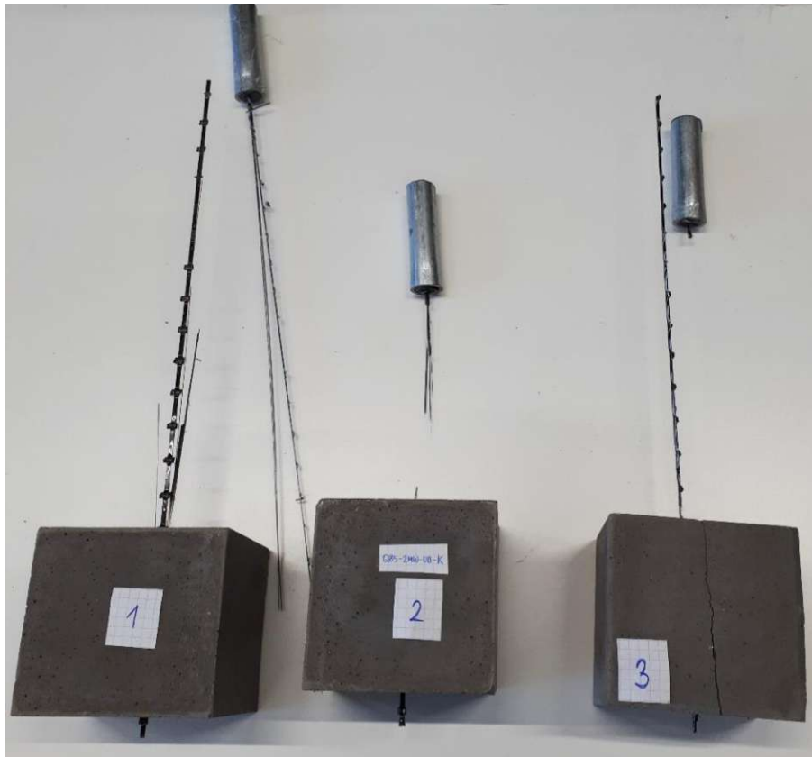
Abb. 8-65: Übersicht der Versagensursachen der Versuchskörper
