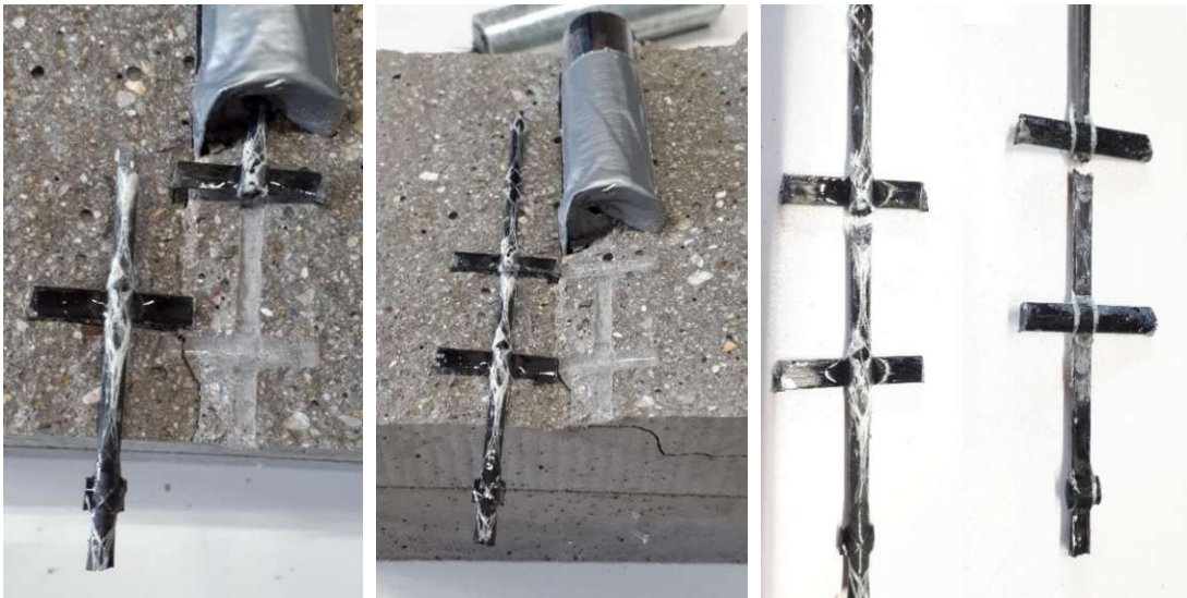
Abb. 8-67: erster Bruch des Prüfrovings (links); zweiter Bruch des Prüfrovings (mittig); Vorder- und Rückseite des Prüfrovings (rechts)
