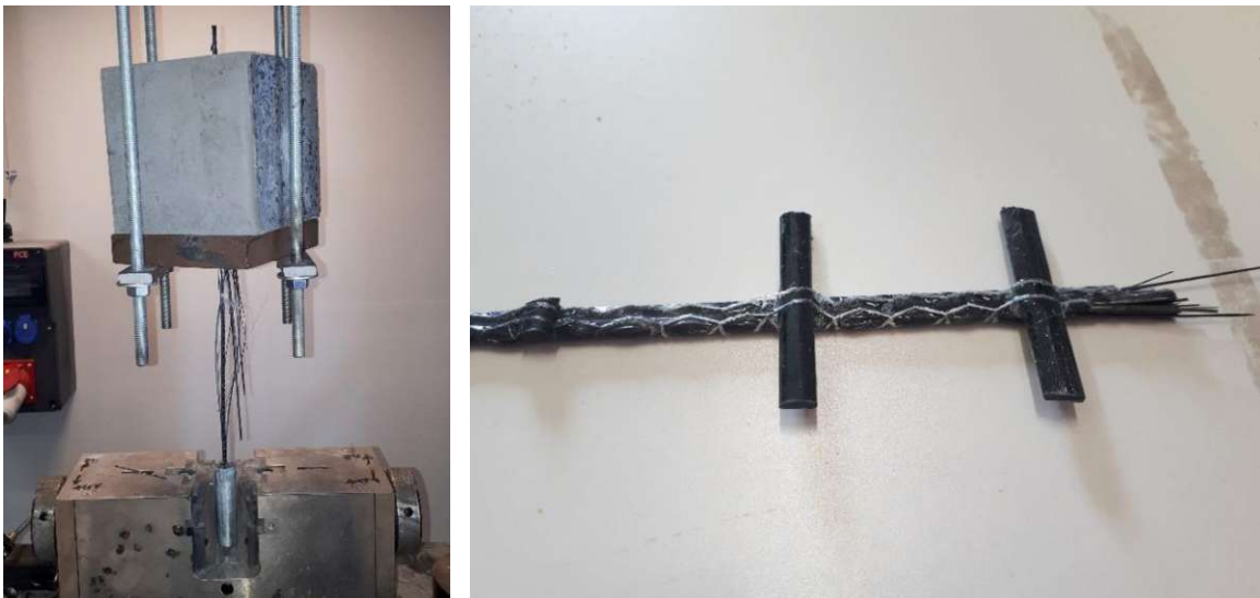
Abb. 8-19: Versagter Versuchskörper (links); verankertes Rovingstück nach Versagen (rechts)
