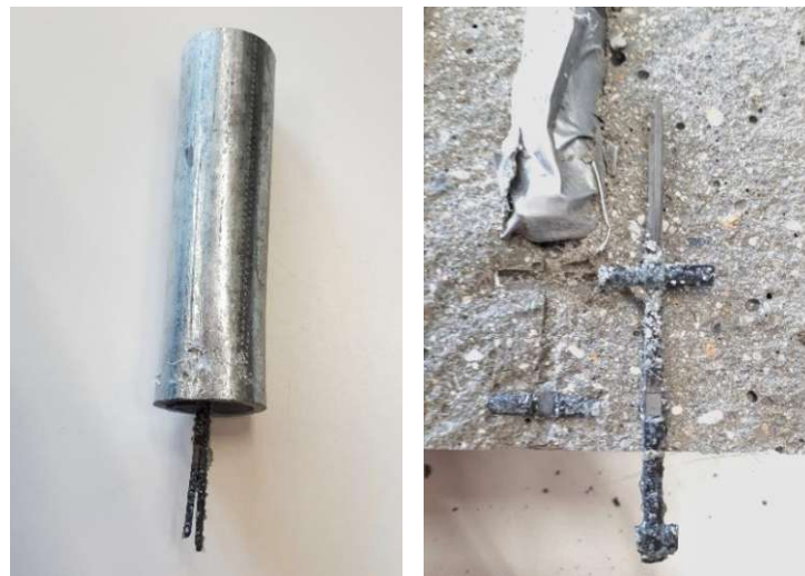
Abb. 8-81: Bruchstelle am Einspannrohr (links); Abgescherter Querroving (rechts)
