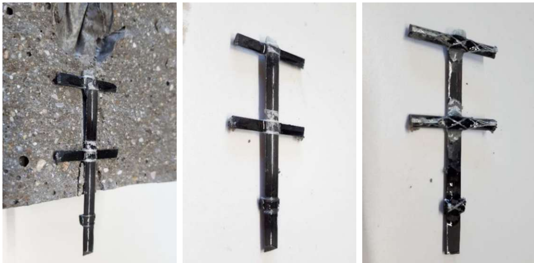
Abb. 8-75: Bruchstelle des Faserstrangs (links); Vorderseite (mittig) und Rückseite (rechts) des Textils im Verbundbereich
