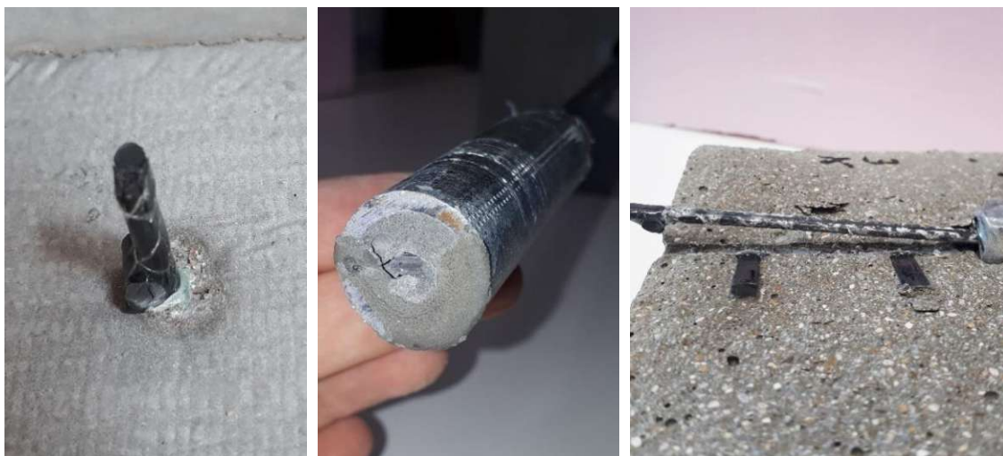
Abb. 8-21: Schlupf am herausschauenden Rovingende (links); Schlupf im Einspannrohr (mittig); abgescherteter Längsroving (rechts)
