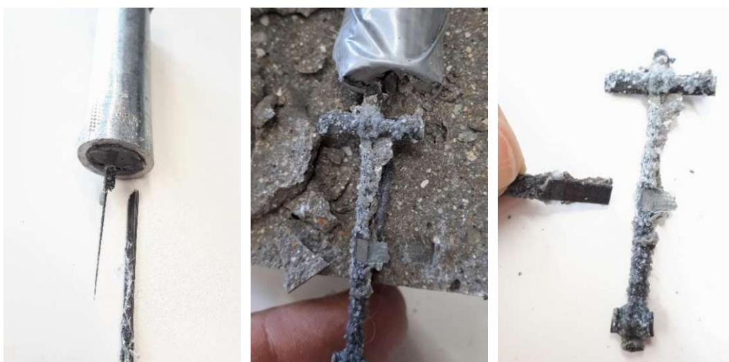
Abb. 8-83: Bruchstelle an der Einspannstelle (links); Bruchstelle im Verbundbereich (mittig); Abgescherter Querroving (rechts)
