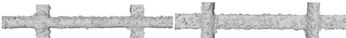
Abb. 7-20: Untersicht Ketroving (links), Schussroving (rechts)
