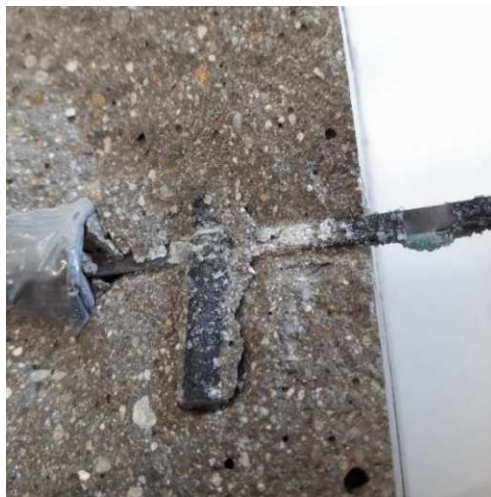
Abb. 8-58: Abgescherter Längs- und Querroving im geöffneten Versuchskörper
