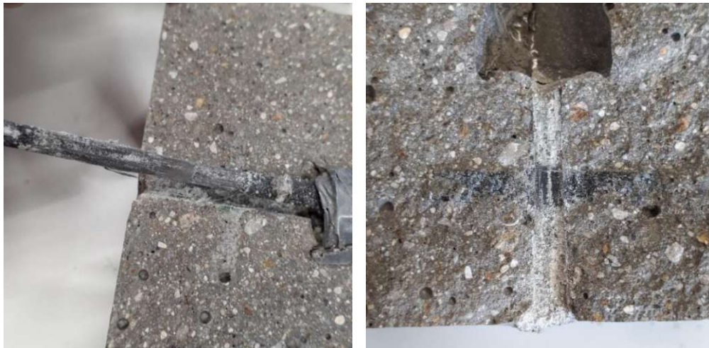
Abb. 8-60: Abgescherter Prüfroving (links); abgescherte Sand-Harz-Beschichtung (rechts)
