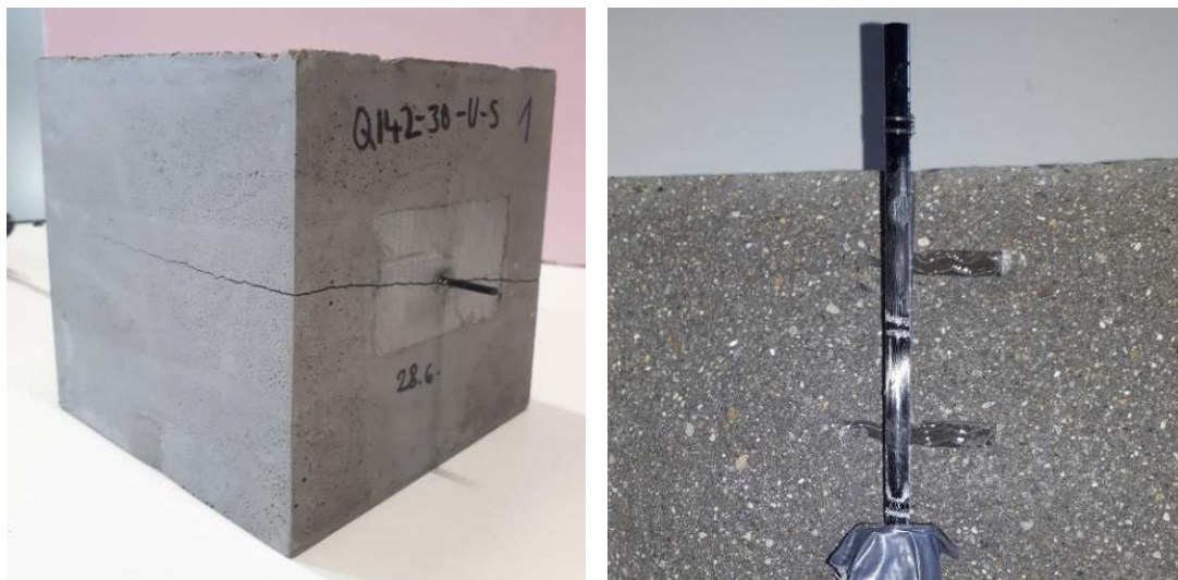
Abb. 8-26: Spaltriss am Probekörper (links); abgescherter Prüfrovings in Endlage (rechts)
