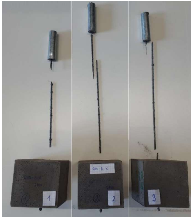
Abb. 8-80: Übersicht der Versagensursachen der Versuchskörper
