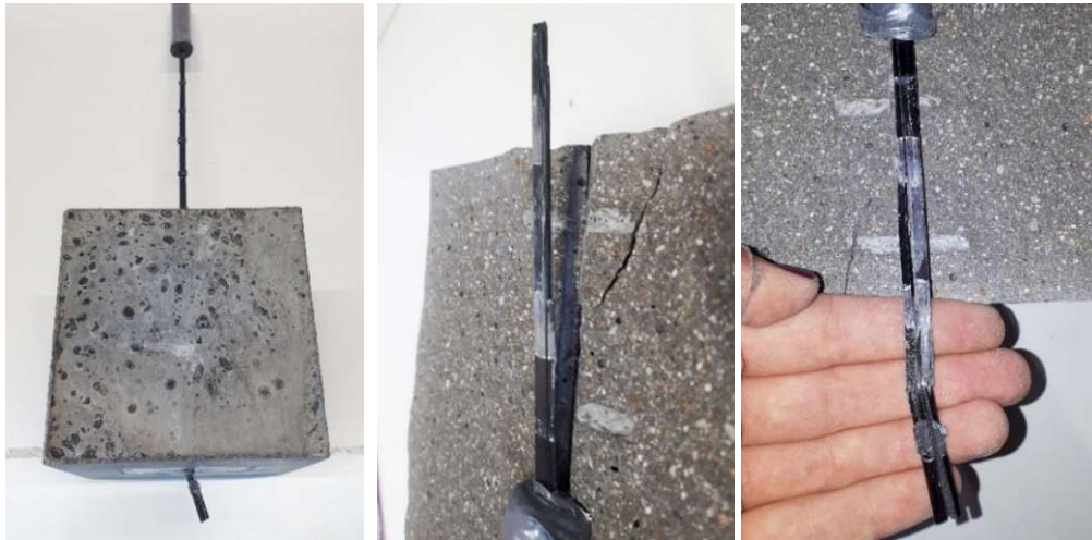
Abb. 8-27: Versagensbild des Prüfkörpers (links); gespaltener Roving (mittig); rekonstruierter Roving (rechts)
