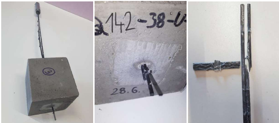
Abb. 8-14: Gespaltener Faserstrang (rechts); herausschauendes Faserstrangende nach Versagen (mittig); zerstörter Faserstrang im Verbundbereich (rechts)
