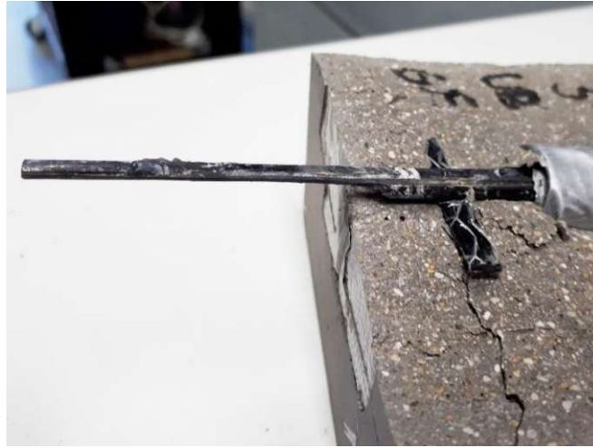
Abb. 8-15: Verbundbereich und Bruchstelle des Rovings im geöffneten Versuchskörper
