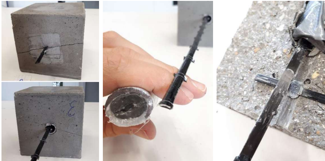
Abb. 8-52: Spaltriss am Probekörper (links); Bruchstelle an der Einspannstelle (mittig); abgescherteter Roving im Verbundbereich (rechts)
