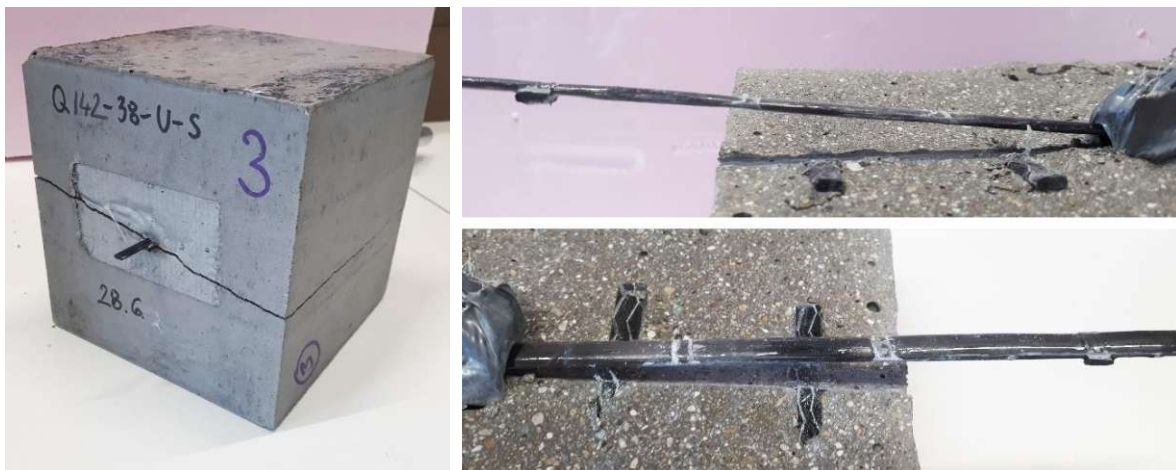
Abb. 8-28: Spaltriss am Probekörper (links); Abgescherter Roving (rechts)
