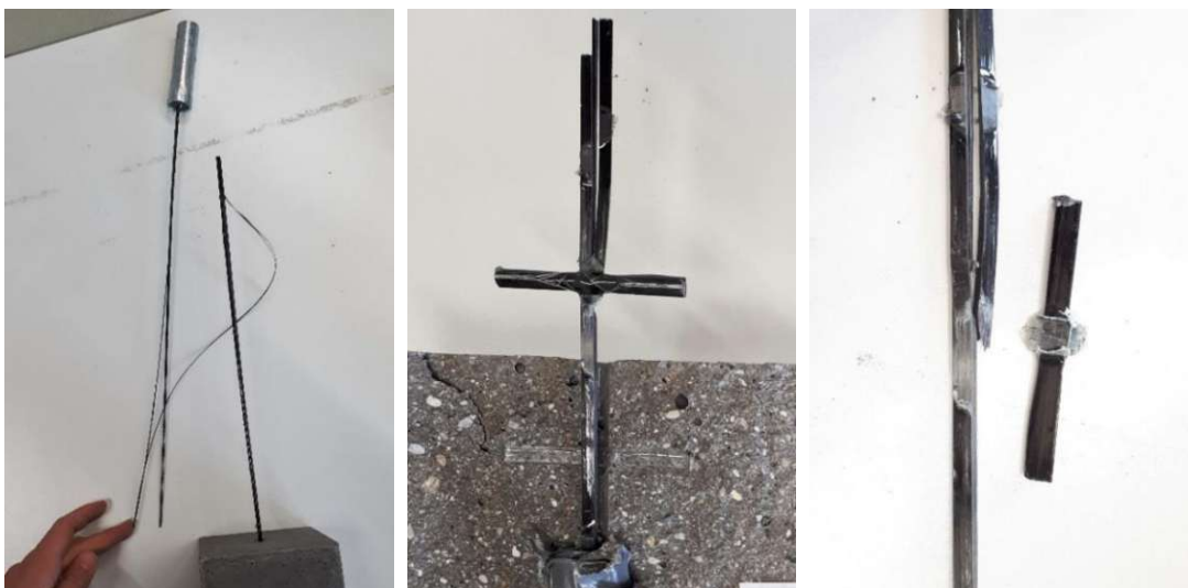
Abb. 8-51: Gespaltener Faserstrang (links); Faserstrangbruchstücke aus dem Verbundbereich (mittig und rechts)
