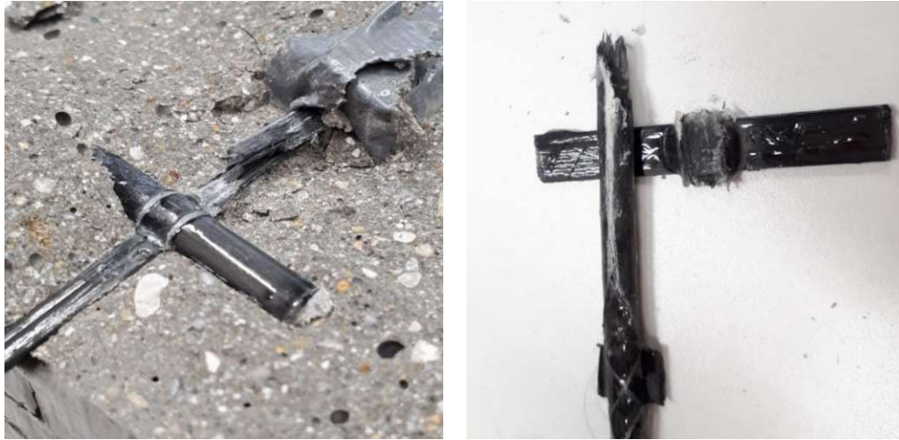
Abb. 8-44: Zerstörter Roving im Verbundbereich: Vorderseite (links) und Rückseite (rechts)
