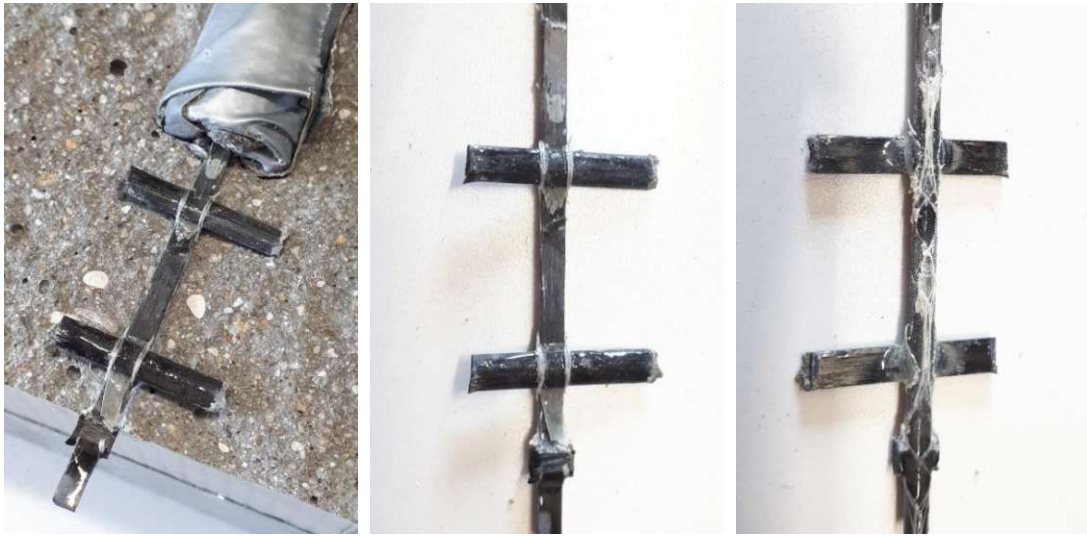
Abb. 8-68: Verbundbereich im geöffneten Versuchskörper (links)
