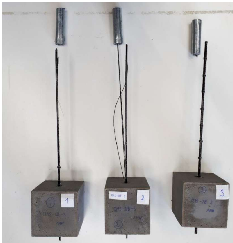
Abb. 8-49: Übersicht der Versagensursachen der Versuchskörper
