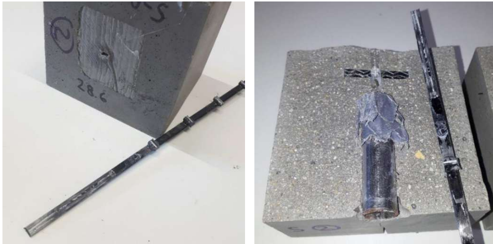
Abb. 8-13: Herausgezogener Roving (links); geöffneter Versuchskörper (rechts)
