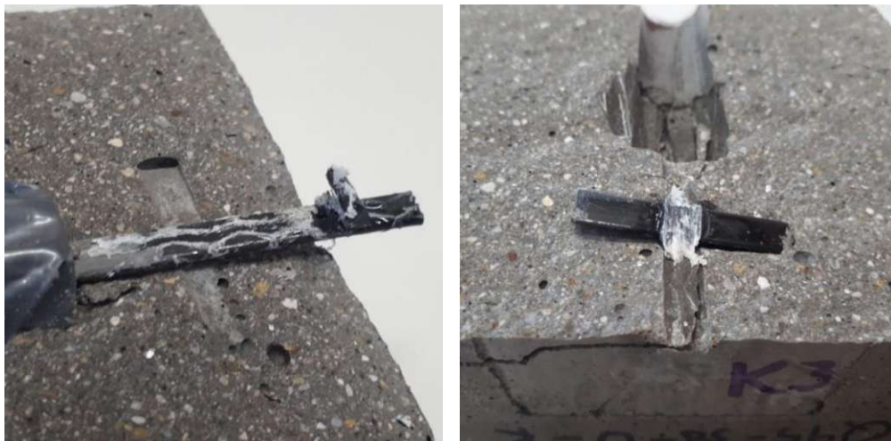
Abb. 8-6: Geöffneter Versuchskörper: abgescherter Testroving (links); abgescherter Querroving (rechts)
