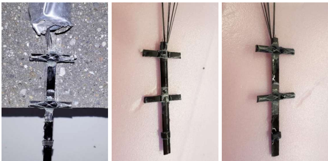
Abb. 8-74: Bruchstelle des Faserstrangs (links); Vorderseite (mittig) und Rückseite (rechts) des Textils im Verbundbereich
