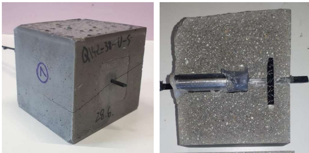
Abb. 8-12: Spaltriss am Versuchskörper (links); geöffneter Versuchskörper (rechts)
