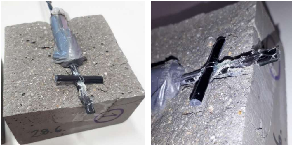
Abb. 8-5: Abgescherter Faserstrang im geöffneten Versuchskörper
