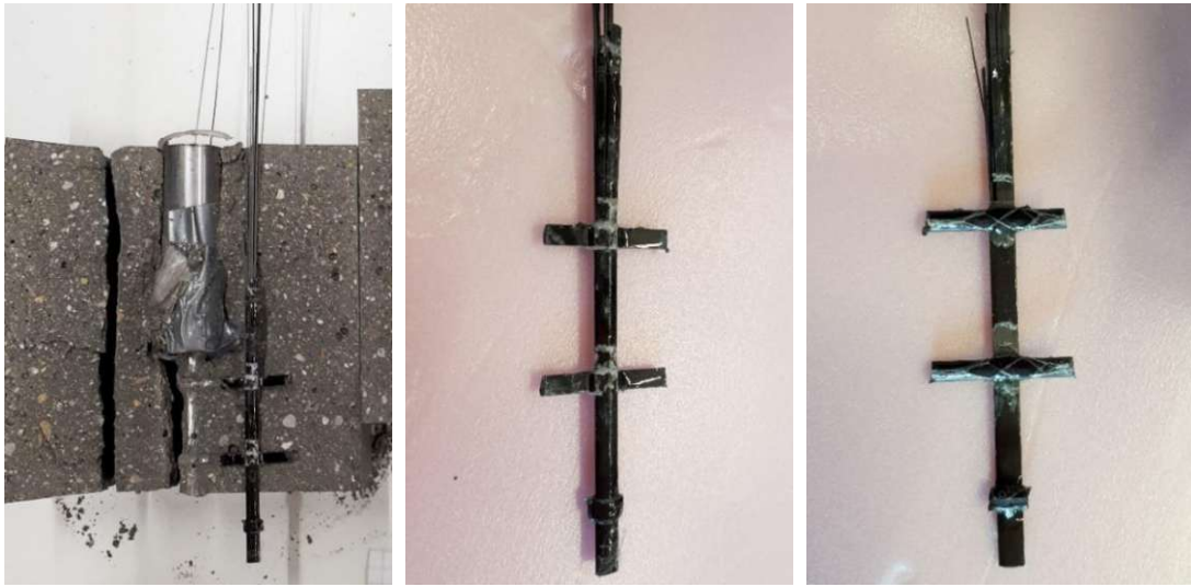
Abb. 8-73: Bruchstelle des Faserstrangs (links); Vorderseite (mittig) und Rückseite (rechts) des Textils im Verbundbereich
