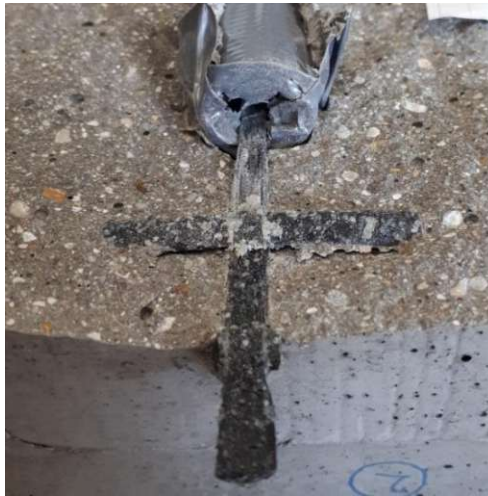
Abb. 8-59: Abgescherter Längs-und Querroving im geöffneten Versuchskörper
