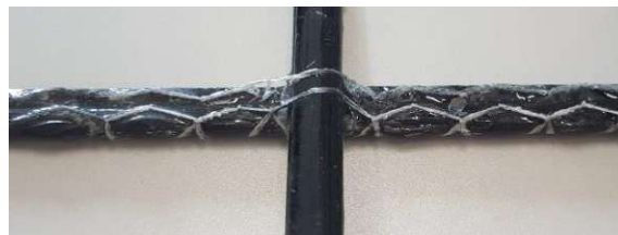
Abb. 5-26: Foto eines Kettrovings Q142-2MW-UB-K nach Versagen
