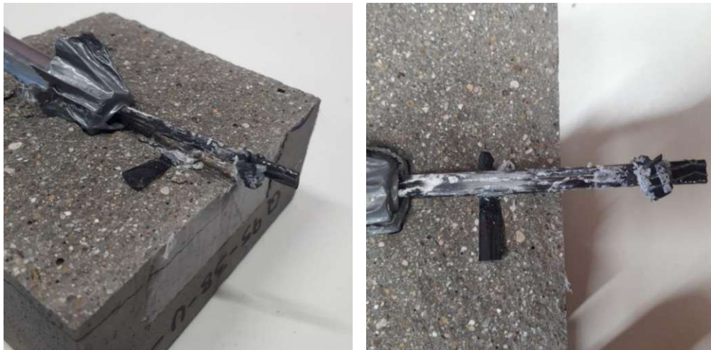
Abb. 8-8: Abgescherter Faserstrang im geöffneten Versuchskörper
