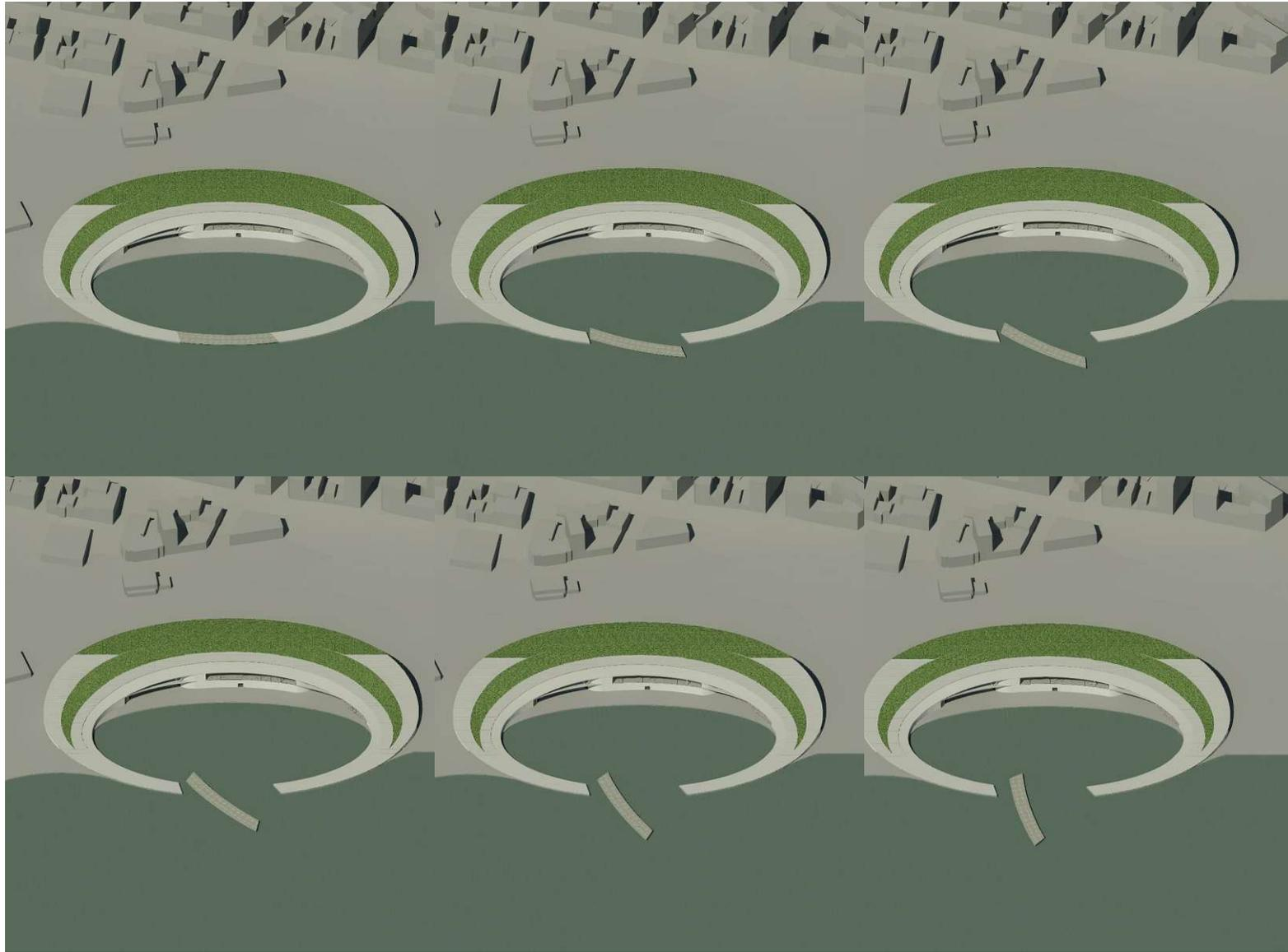
Abb. 48: Drehbrücke Öffnungssystem
