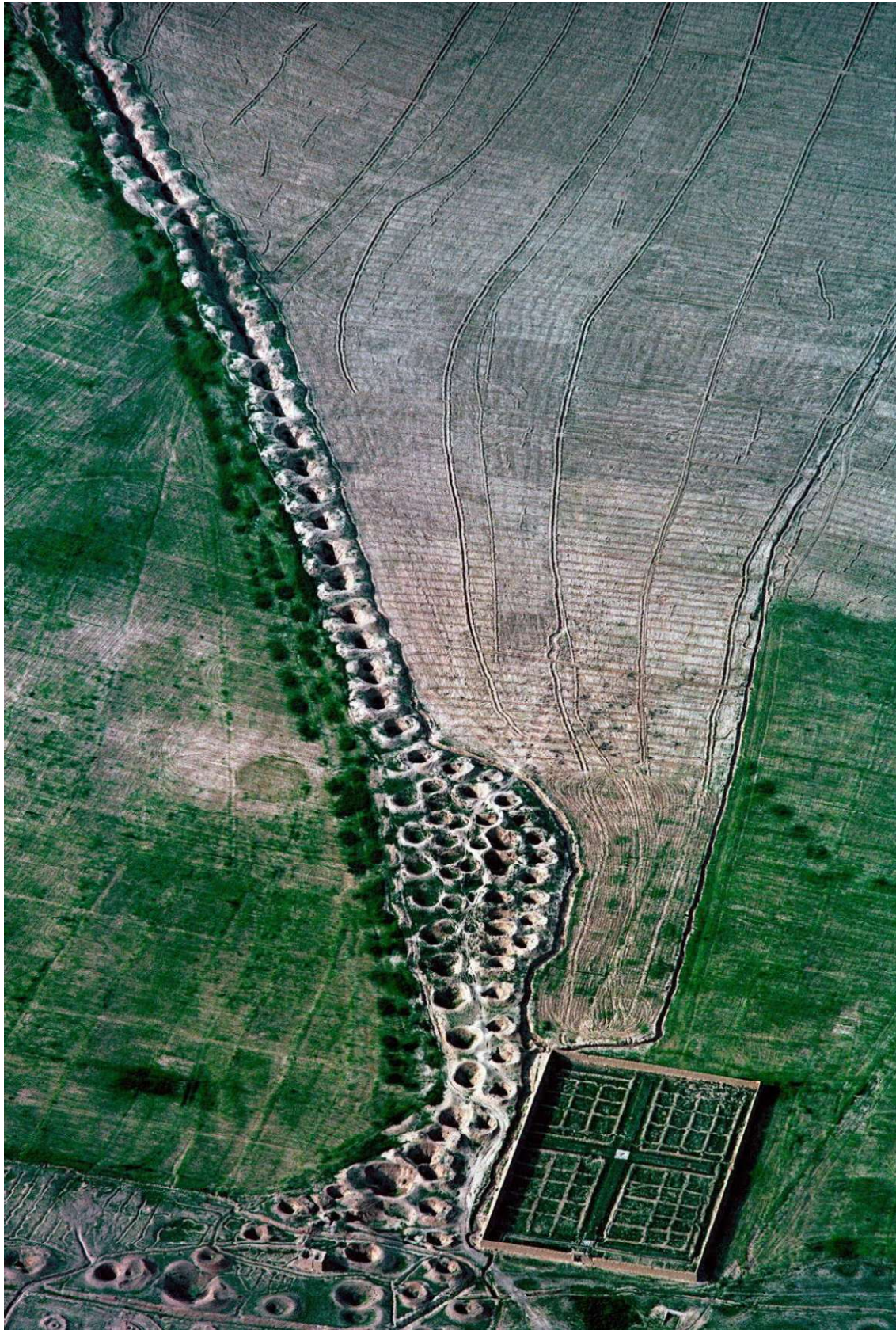
Abb1.29 : Qanat System, Frischwasserförderung in Wüstengebieten im Iran
