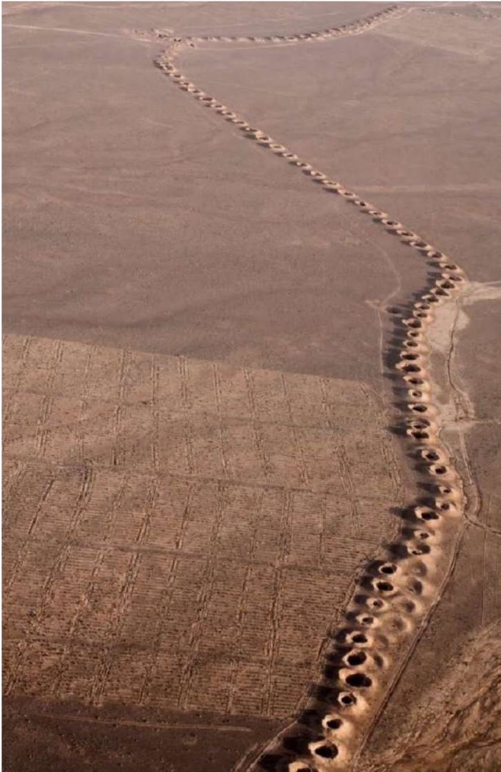
Abb1.23 : Qanat, Frischwasserförderung in Wüstengebieten im Iran
