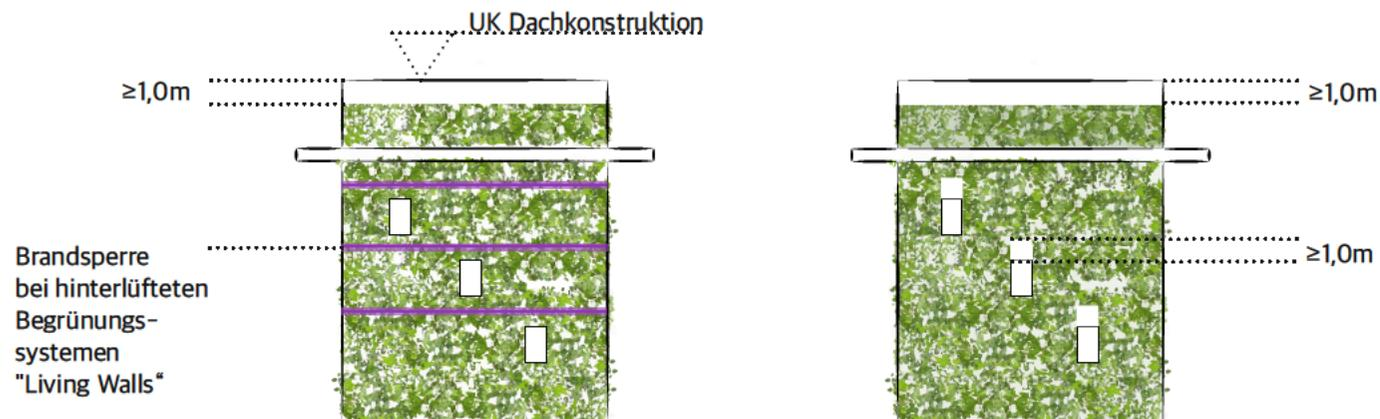
Horizontale und vertikale Abstände zwischen den Modulen an der Fassade können mit der Verhinderung der Brandweiterleitung helfen. Es würde aber weitere Maßnahmen benötigen, die mit einem separaten Brandschutzkonzept und Planung berücksichtigt werden müssen.
