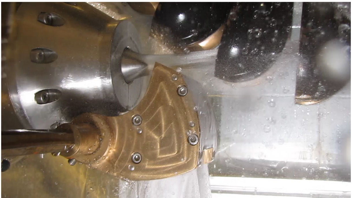
Abbildung 5.10: Strahlablenker im Einsatz
