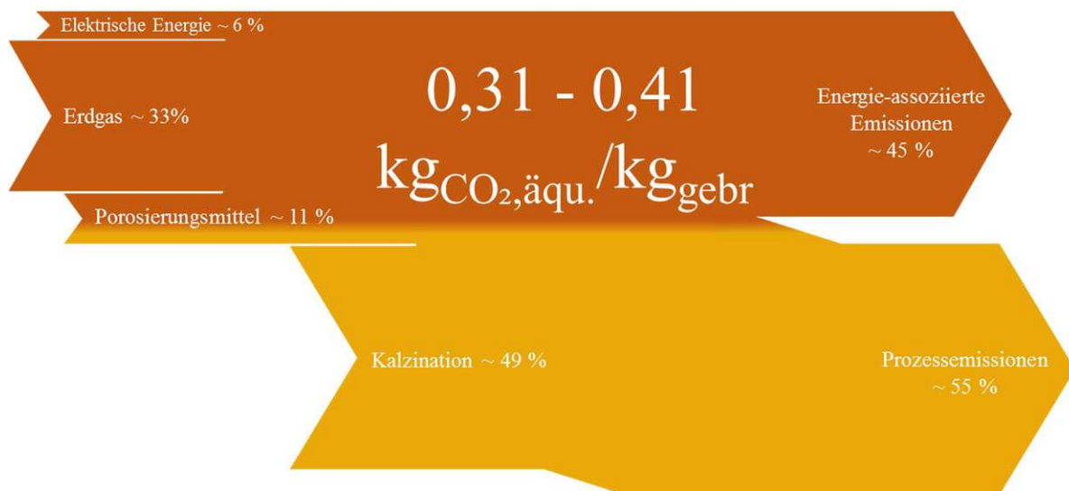
Abbildung 5: CO 2 -Quellen und –Prozessaufwendungen. Die CO 2 -Emissionen des Gesamtprozesses entfallen zu etwa 45 % auf die Energiebereitstellung und 55 % auf die prozessbedingten Emissionen durch Kalzination des in der Tonmischung vorhandenen Kalks.
