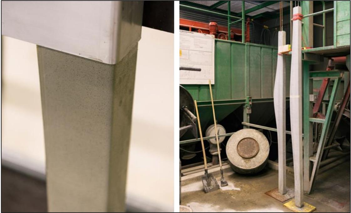
Abbildung 18: „Smart Dynamic Casting“-Verfahren im Detail 2; links: Schrittweises vertikales Drucken des Bauteils, rechts: Fertiges Bauteil (Stützpfeiler)
