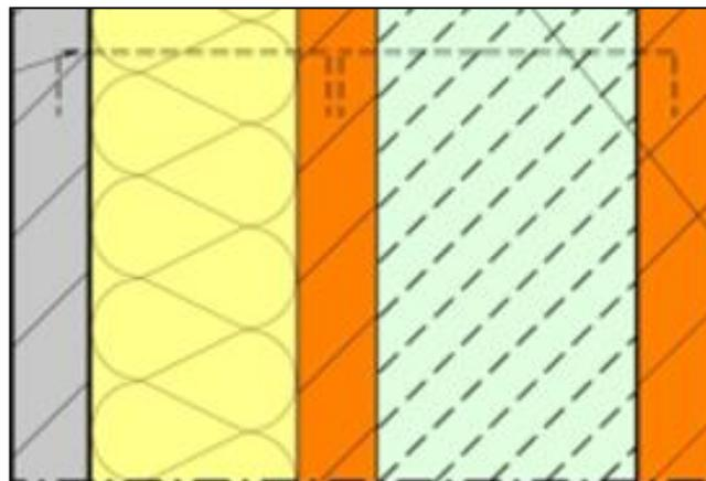
Abbildung 36: Detail zu zweischaliger Außenwand mit Ortbetonkern
