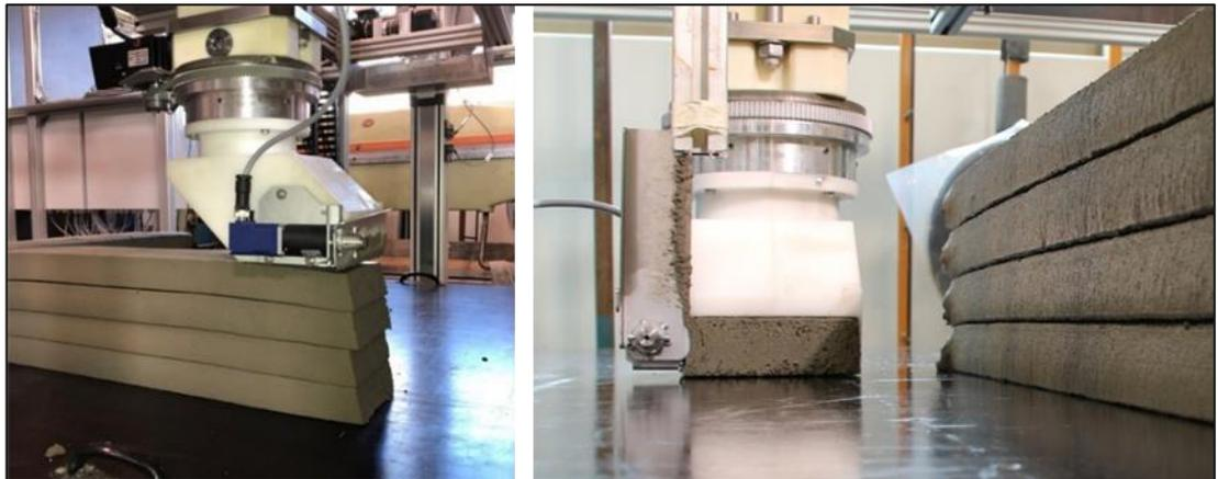
Abbildung 12: Darstellung zeigt Feldversuche einer Grobfilamentablage (u.a. CONPrint3D-Verfahren)
