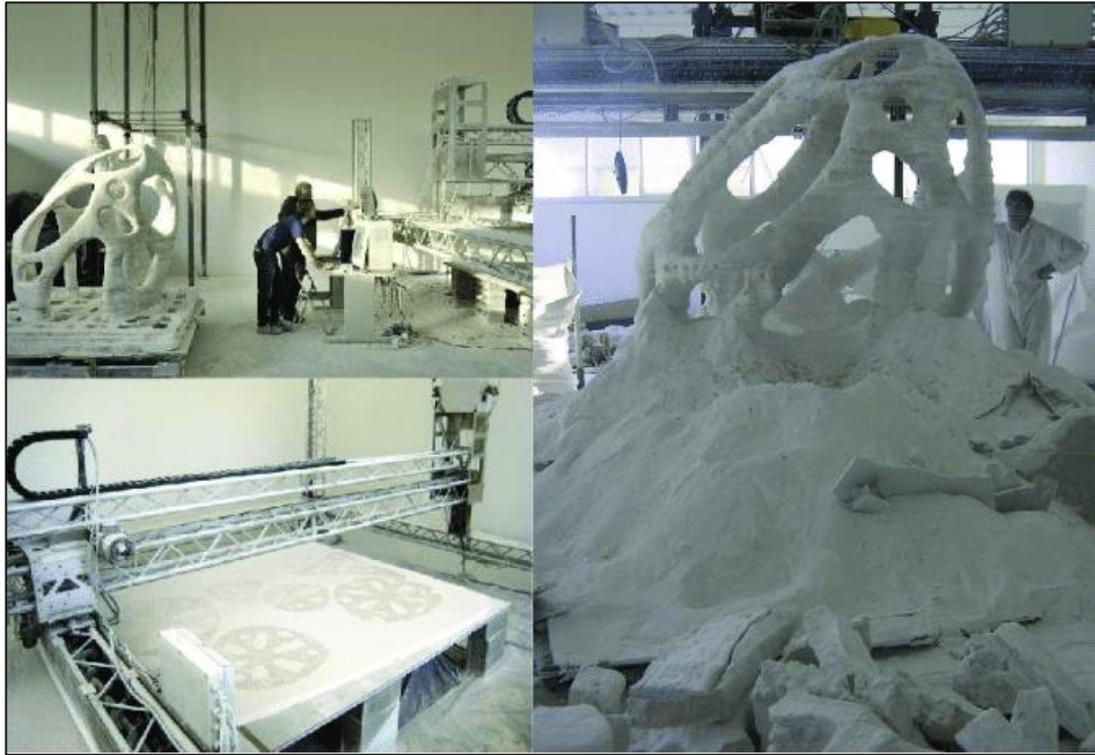
Abbildung 8: Darstellung zeigt einen werksbasierten Partikelbett-Drucker der Festkörper in einer Abmessung von 6 x 6 x 6 m auf Basis des D-Shape-Verfahrens drucken kann
