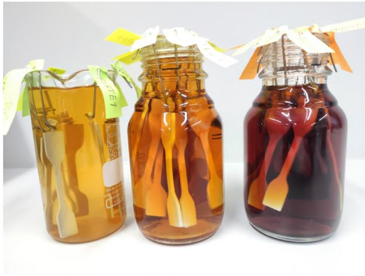
**Abbildung 70** Auslagerungsversuche mit Essig nach 14 Tagen bei unterschiedlichen Temperaturen, links: Raumtemperatur, mitte: 40°C, rechts: 60°C
