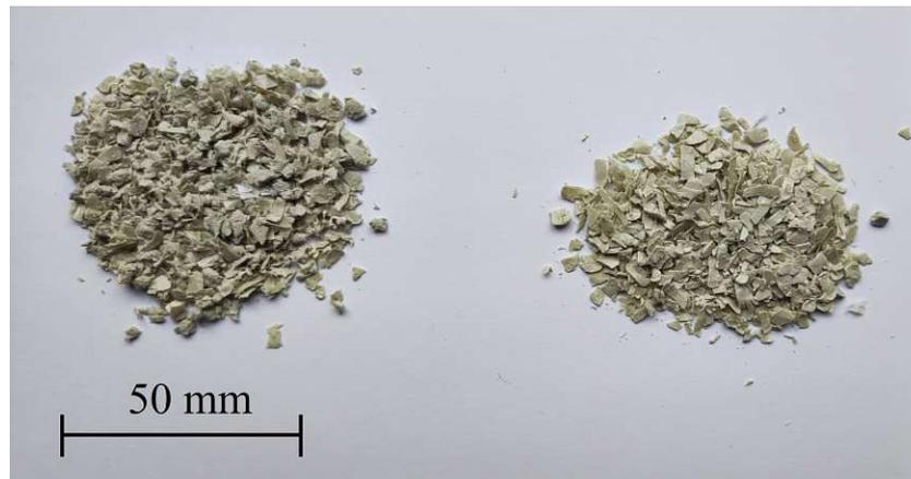
**Abbildung 13** rPS Mahlgut: aus dem Schredder (links) und der Schneidmühle (rechts)
