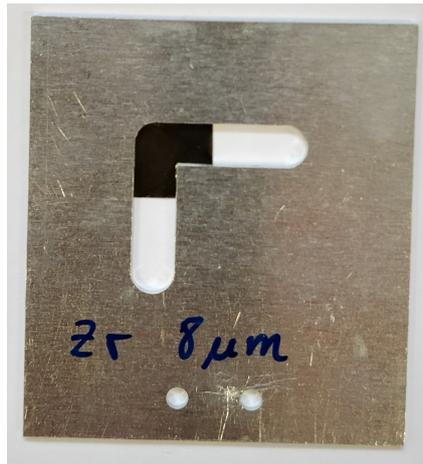
Abbildung 5.18: **Zr-Folie auf Aluminiumrahmen.** Befestigung 8  $\mu\text{m}$  dünner Folie aus Zr auf dem Probenträgerrahmen zur Durchführung der Knife-Edge-Scans in beide Richtungen.
