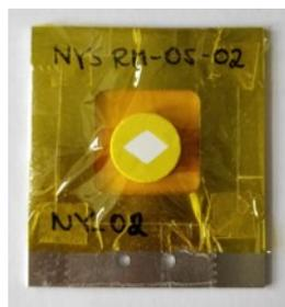
Abbildung 6.11: **NYS-Standard.** Befestigung der Pellets auf Kapton-Klebefolie und bedeckende Schicht aus 8  $\mu\text{m}$  dünner Kapton-Folie mit Fenster.
