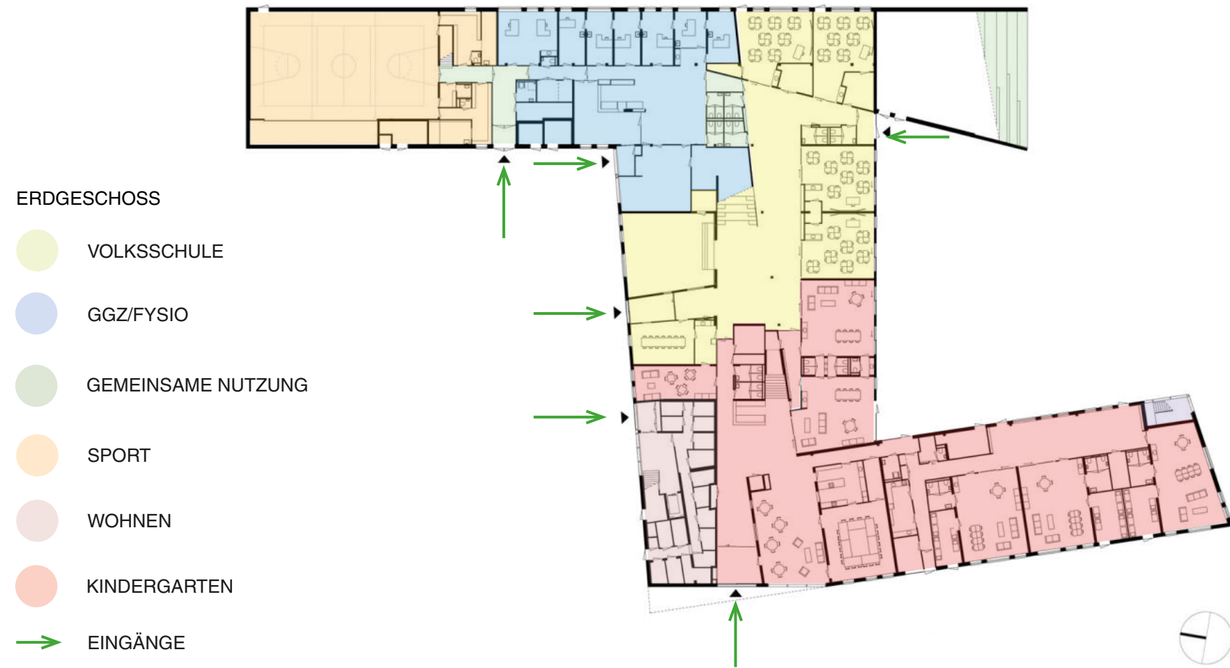
Abb.15: MFA Nelson Mandela Centrum: Funktionsaufteilung im Erdgeschoss. Eigene Darstellung auf Basis von Plänen von ATELIER PRO Architecten.
