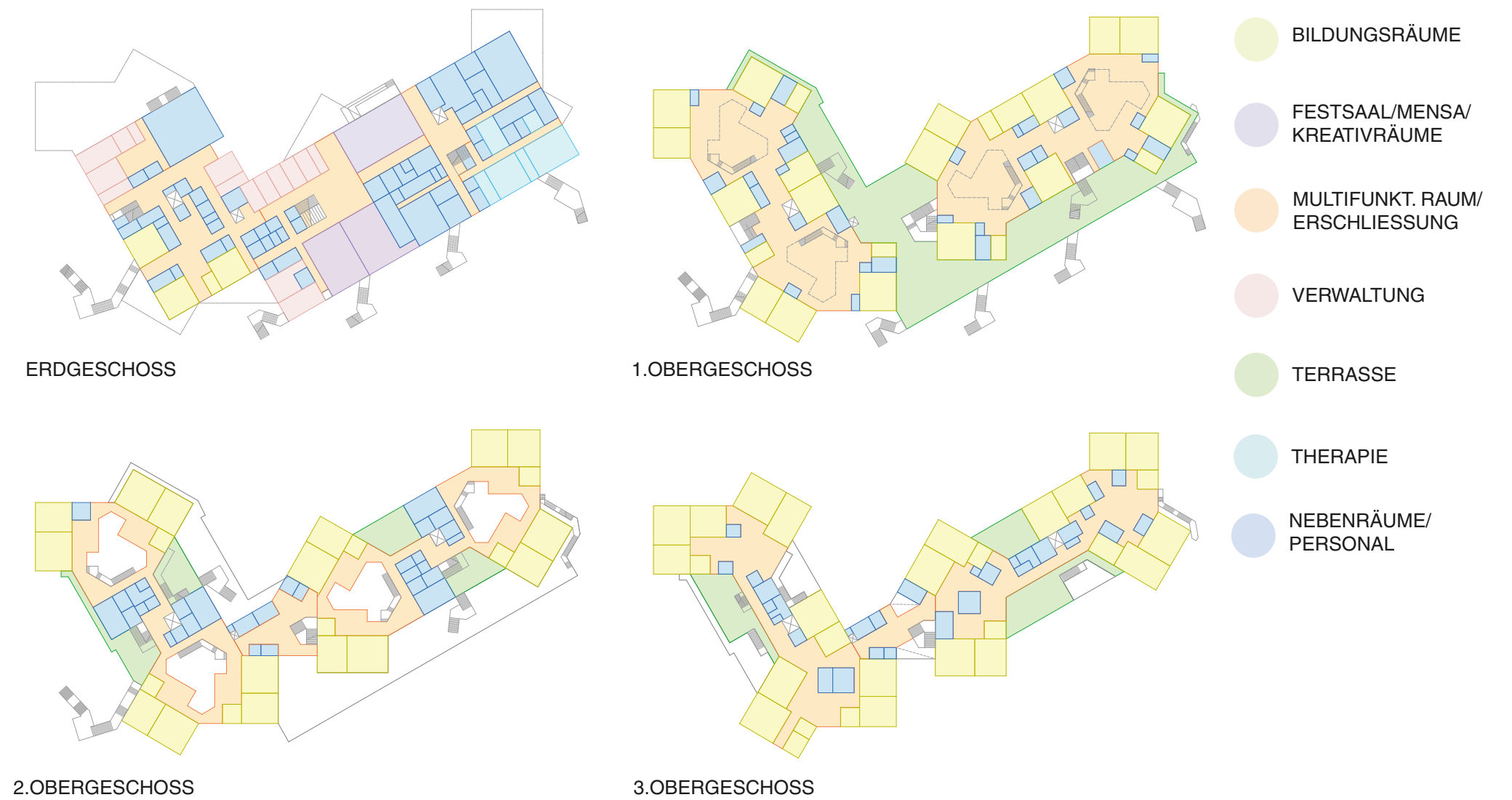
Abb.57: Bildungscampus Berresgasse: Diagramme zur Nutzungsaufteilung in den Grundrissen. Eigene Darstellung.
