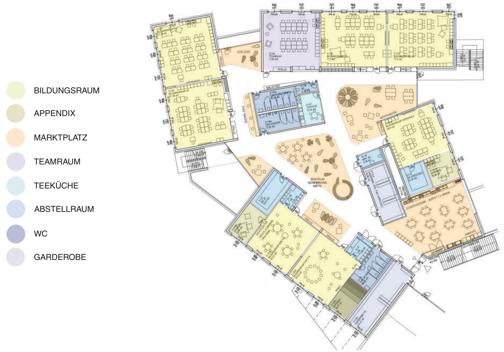
Abb.72: Bildungscampus Nordbahnhof: Beispiel eines Bildungsbereichs. Eigene Darstellung auf Basis von Plänen von Klammer Zeleny Architekten.
