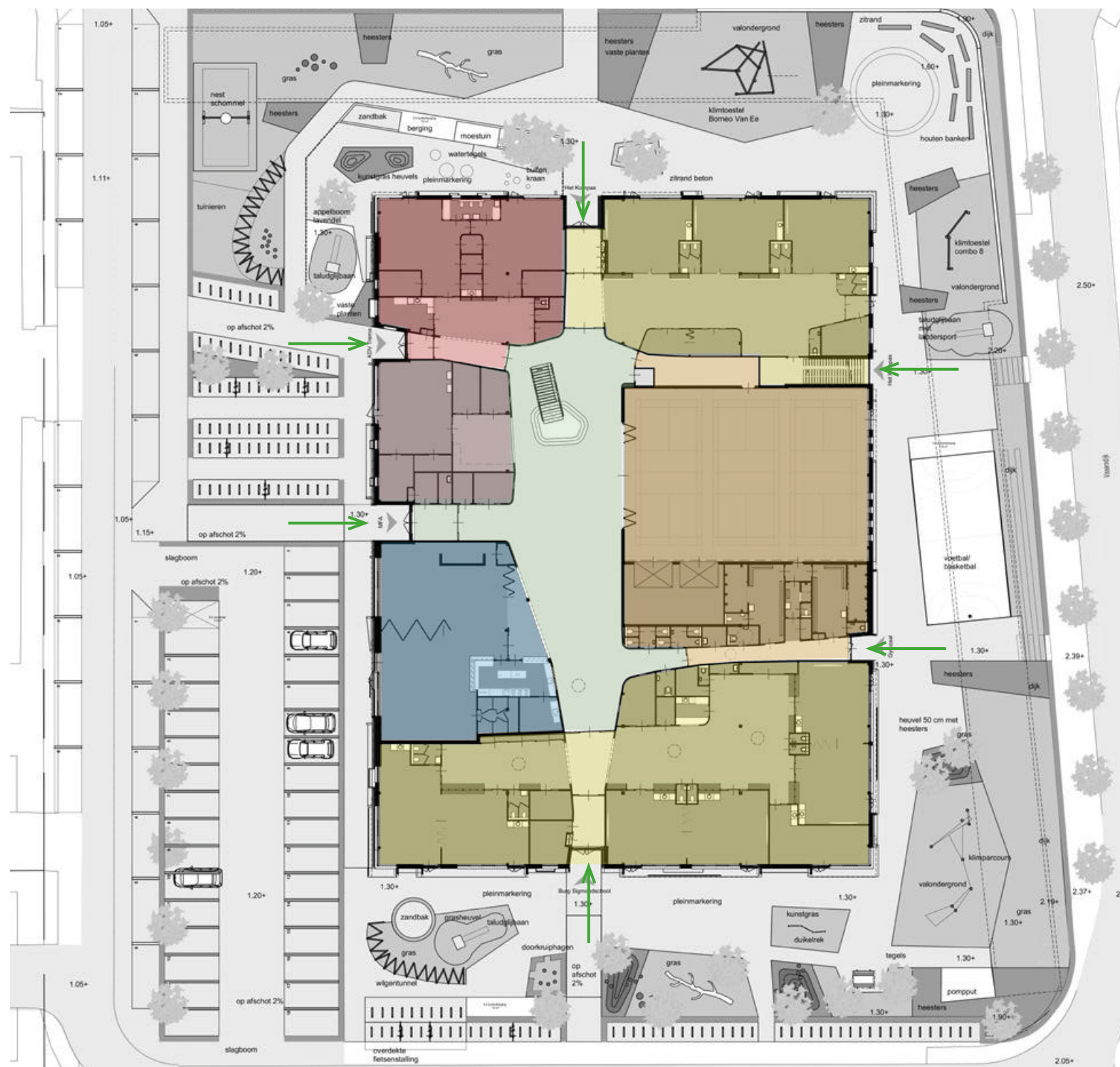
Abb.10: MFA Vlechtwerk: Funktionsaufteilung im Erdgeschoss. Eigene Darstellung auf Basis von Plänen von Olivier Architecten und NO LABEL.
