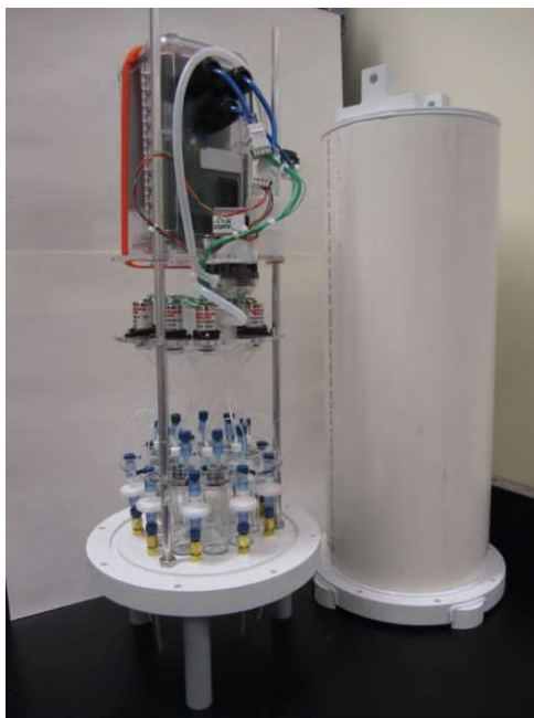
(a) Autosampler - Innenansicht
