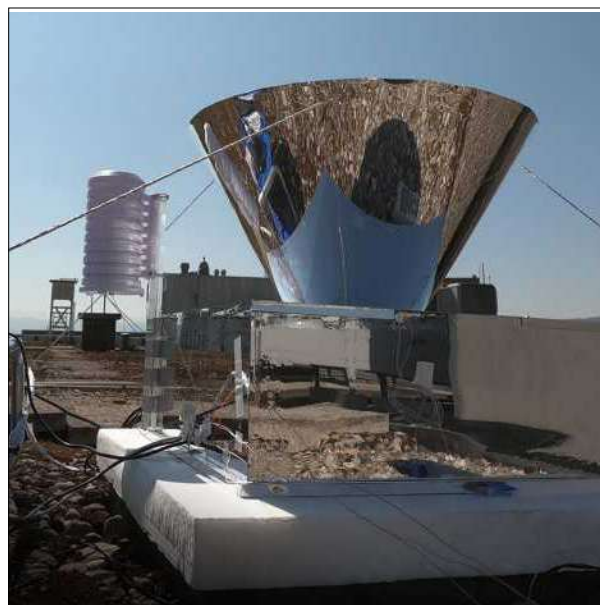
Abb. 25: Strahlungskühlkondensator ETH Zürich
