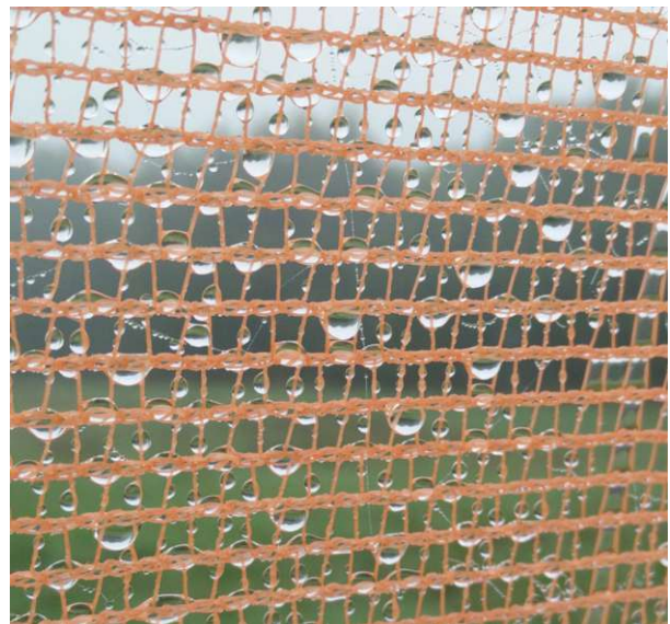
Abb. 31: Warka Tower-Netz mit Wassertröpfchen
