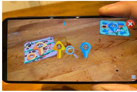
Abbildung 4.28: Initiale Kalibrierung des Spielfeldes durch Marker-Suche
