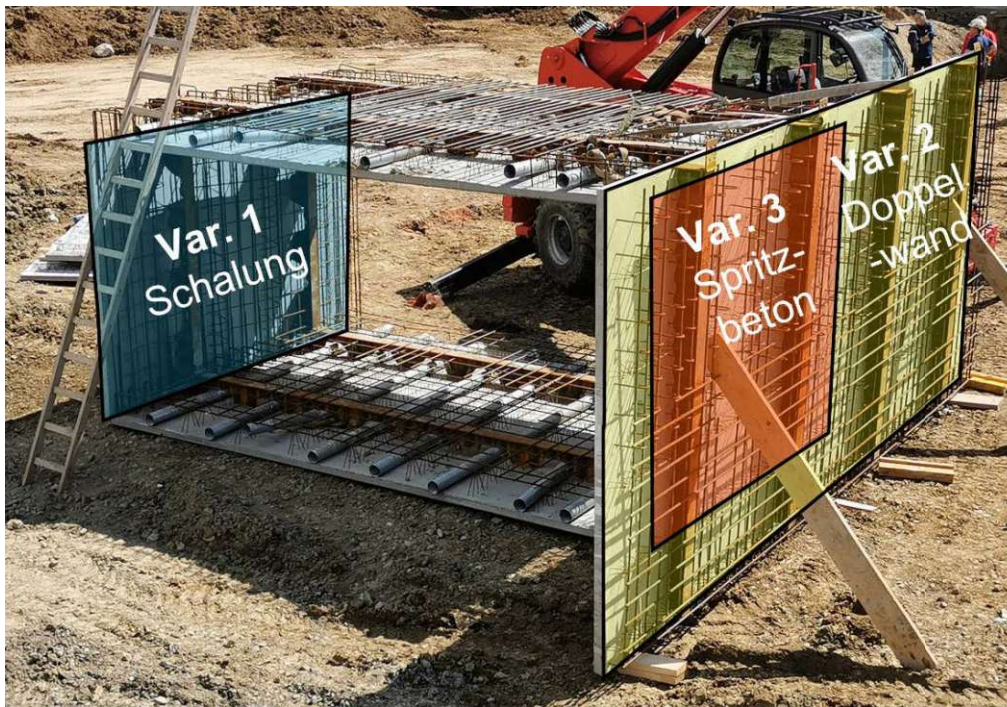
Bild 2 Versuchsaufbau zur Ergänzung eines Brückensegments mit Ortbeton. Kennzeichnung der drei Versuchsfelder (Foto: Stephan Fasching)
