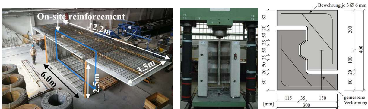
(a) Querkraftübertragende Bauteile in Halbfertigteilsegmenten, blau: Querrahmen, Orange: Segmentfugen, entnommen aus [2] (b) Längsschubversuche Trapezblechstege, entn. aus [45] (c) Schubversuche an Fugen mit Schubnocken, entnommen aus [51]
