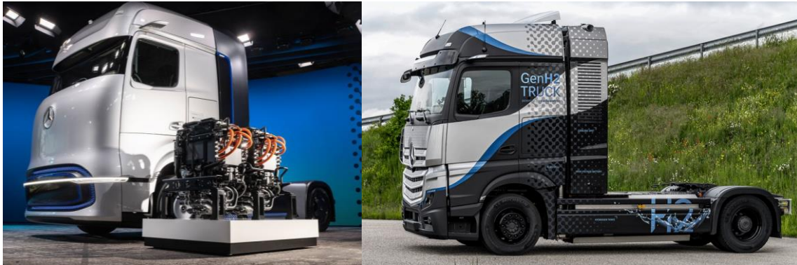
Abbildung 20: Mercedes Benz GenH2 Sattelzugmaschine (links: Designstudie inkl. Brennstoffzellenaggregat; rechts: fahrbereiter Prototyp) [76], [77]
