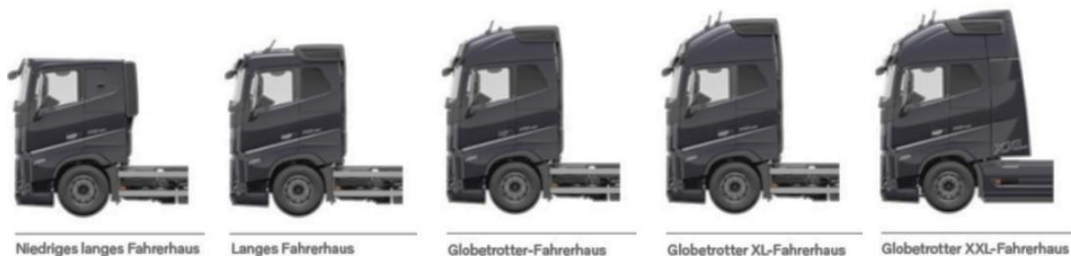
Abbildung 9: Fahrerhäuser von Volvo Sattelzugmaschinen für den regionalen Einsatz (links) bis hin zum Einsatz im internationalen Fernverkehr (rechts) [28]
