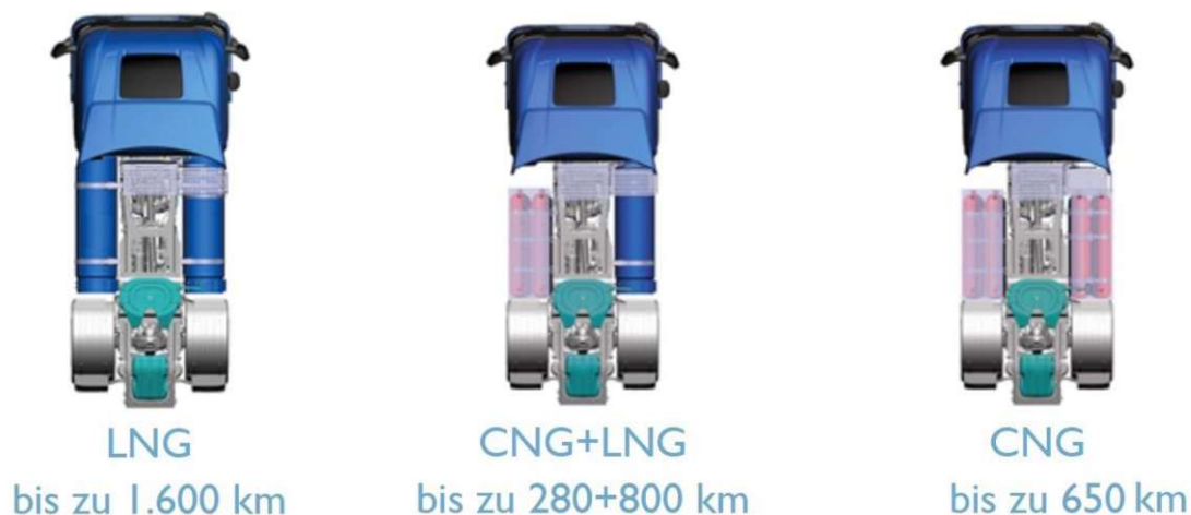
Abbildung 14: Auszug von verfügbaren Tankkonfigurationen für LNG bzw. CNG bei einem IVECO S-Way [57]
