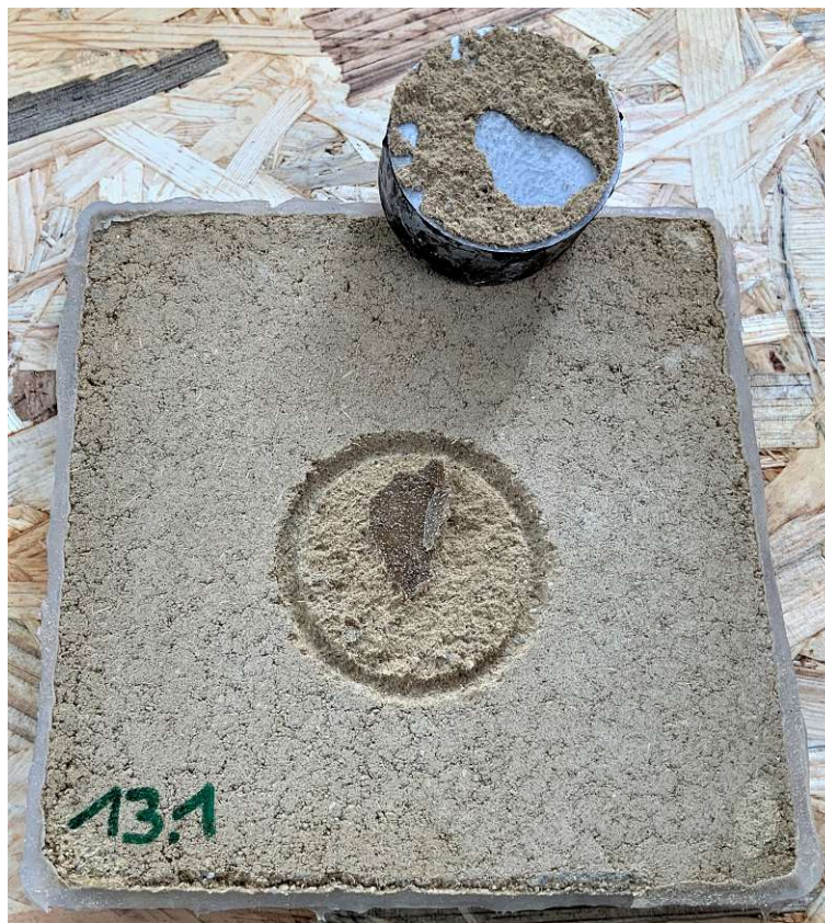
Abb. 5.24: Zerstörter Probekörper mit 1.5 Ma% Holzfasern nach der Haftzugfestigkeitsprüfung; Kohäsionsversagen innerhalb des Klebers
