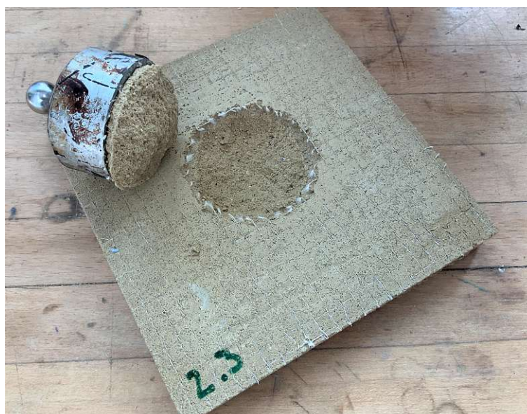
Abb. 5.10: Zerstörter Probekörper mit kreisförmig durchtrenntem Flachsgewebe vor Haftzugfestigkeitsprüfung
