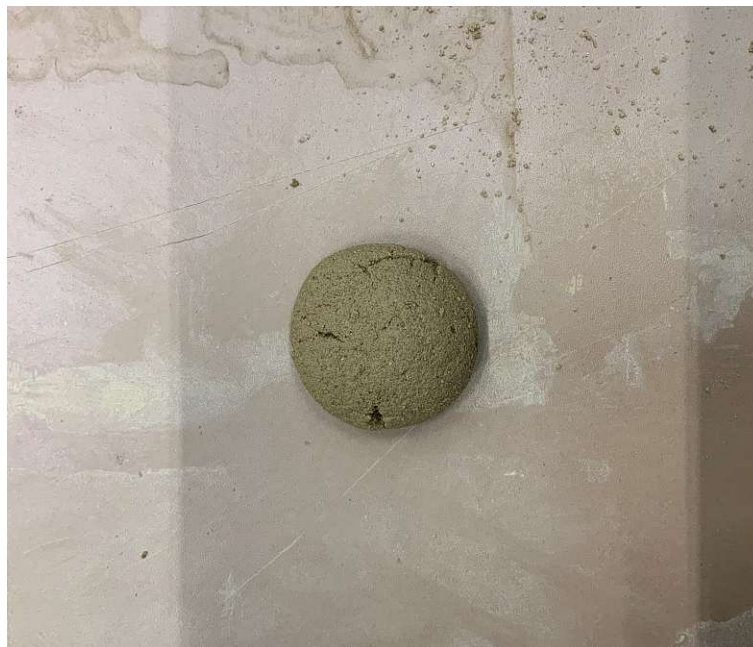
Abb. 4.8: Optimierte Mischung: 250 g LFP, 39,38 g Wasser, 12,5 g TLP
