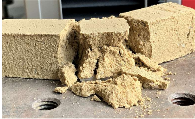
Abb. 5.6: Zerstörter Probekörper mit sichtbaren kegelförmigen Ausbrüchen
