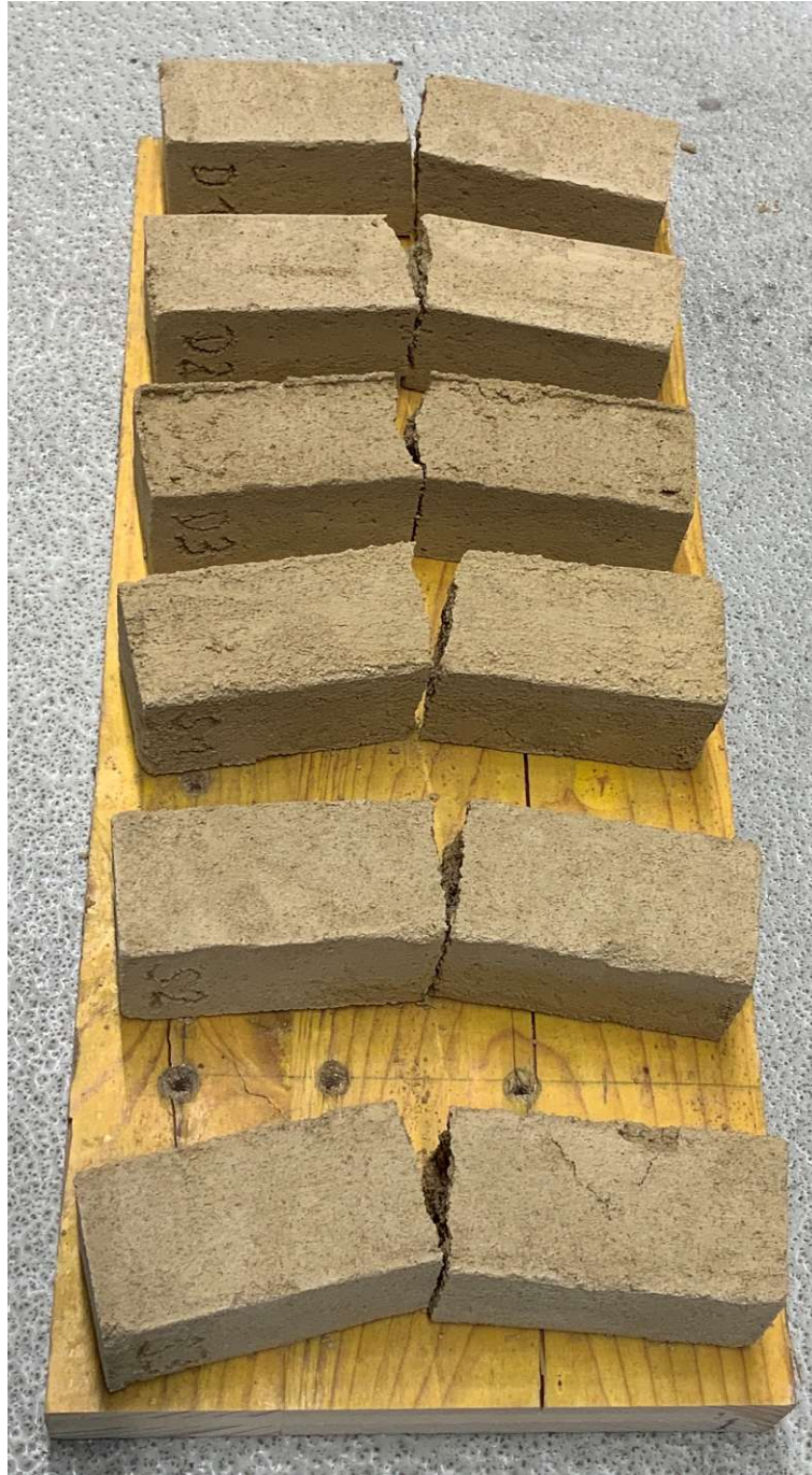
Abb. 5.2: Zerstörte Probekörper nach der Biegezugfestigkeitsprüfung, D1-D3 und S1-S3
