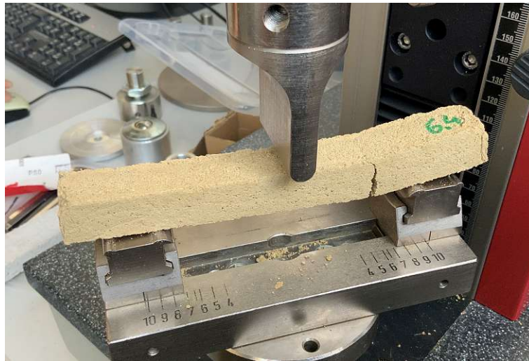
Abb. 5.16: Zerstörter Probekörper mit 1 Ma% Kasein mit Biegeversagen durch Materialinhomogenitäten beim Dreipunkt-Biegeversuch
