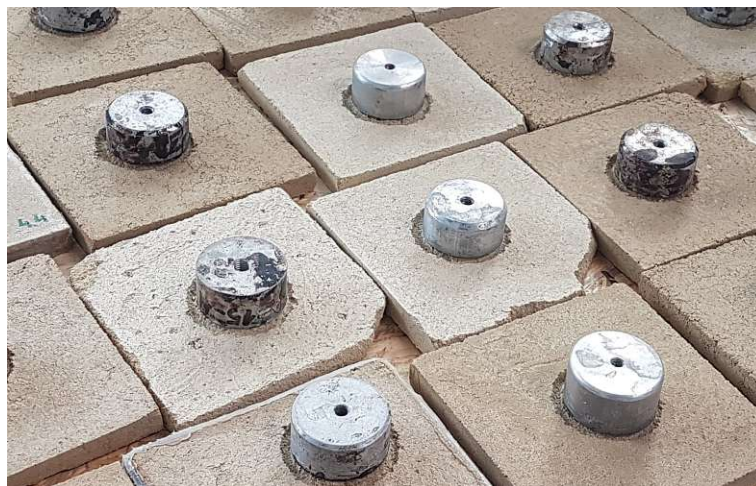
Abb. 4.18: Aufgelebte Prüfstempel für Haftzugfestigkeitsprüfung
