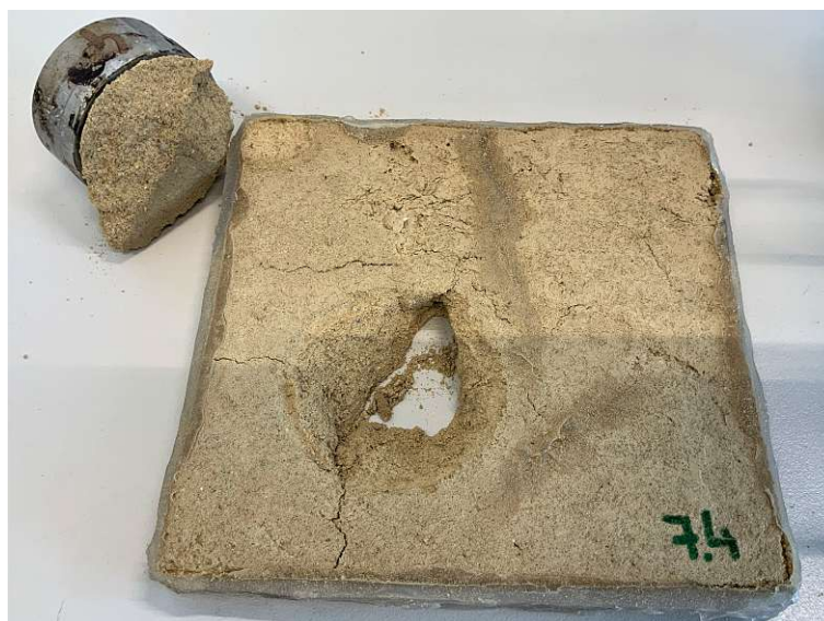
Abb. 5.20: Zerstörter Probekörper mit 5 Ma% Kasein nach der Haftzugfestigkeitsprüfung
