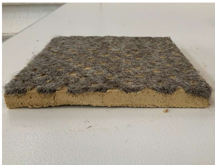
Abb. 4.3: Fertiger Probekörper mit Filz
