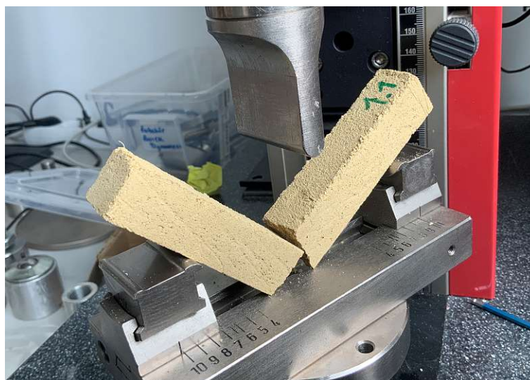
Abb. 5.5: Zerstörte Probe M1.1 nach dem Dreipunkt-Biegeversuch
