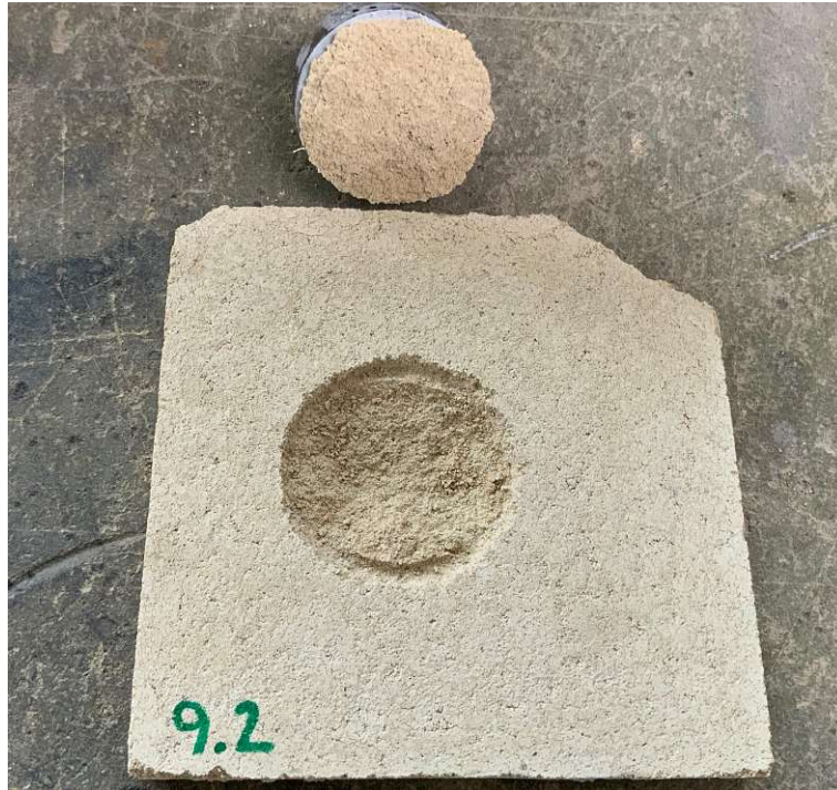
Abb. 5.22: Zerstörter Probekörper mit 4 Ma% gelöschtem Kalk nach der Haftzugfestigkeitsprüfung
