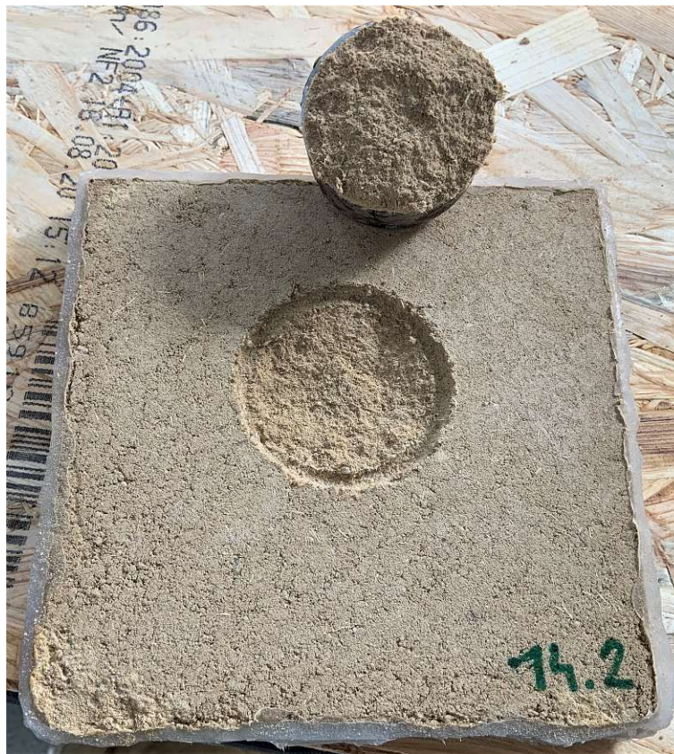
Abb. 5.25: Zerstörter Probekörper mit 2.5 Ma% Holzfasern nach der Haftzugfestigkeitsprüfung
