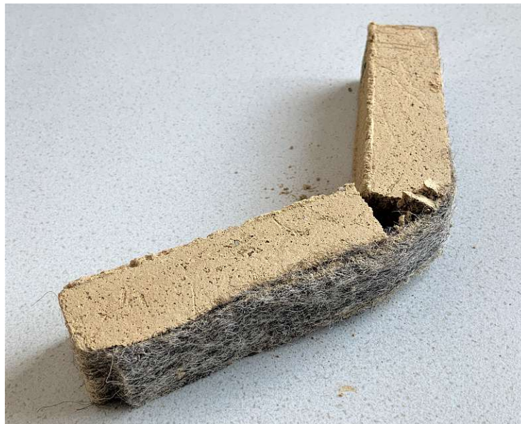
Abb. 5.13: Zerstörter Probekörper mit Filzmattenbewehrung nach dem Dreipunkt-Biegeversuch
