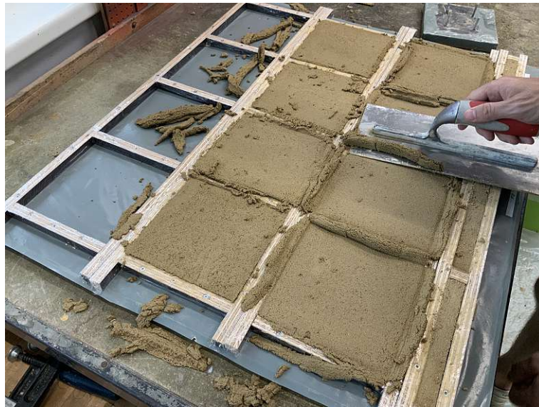
Abb. 4.12: Probekörper mit überschüssigem Material nach Verdichtung
