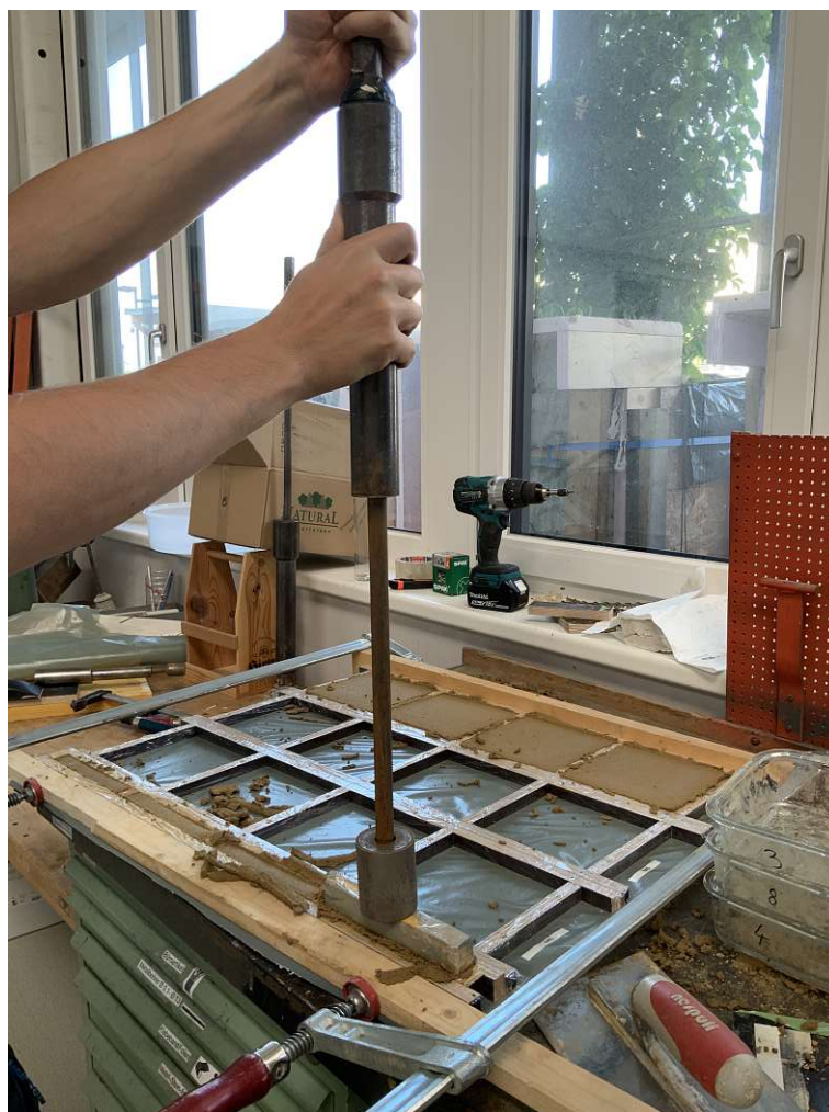
Abb. 4.10: Proctorhammer mit Fallgewicht und Lastverteilerplatte
