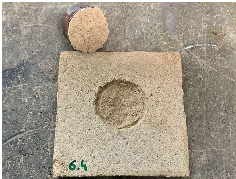
Abb. 5.19: Zerstörter Probekörper mit 1 Ma% Kasein nach der Haftzugfestigkeitsprüfung
