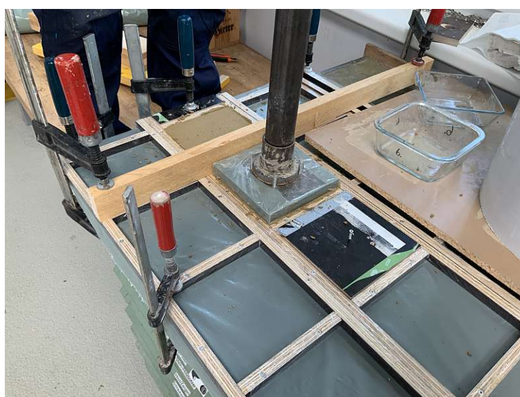
Abb. 4.11: Lastverteilerplatte mit Zentriervorrichtung
