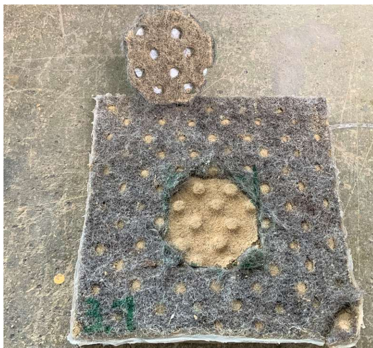
Abb. 5.15: Zerstörter Probekörper mit Filzmattenbewehrung nach der Haftzugfestigkeitsprüfung
