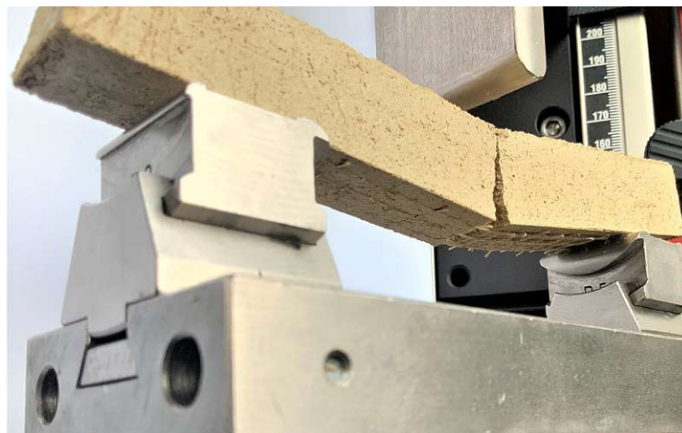
Abb. 5.9: Zerstörte Probe nach dem Dreipunkt-Biegeversuch
