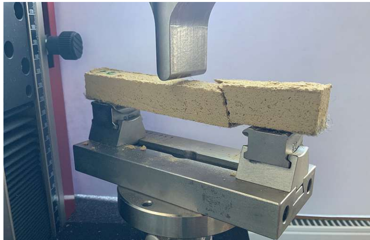
Abb. 5.14: Zerstörter Probekörper mit Filzmattenbewehrung beim Dreipunkt-Biegeversuch, Bruch in Auflagernähe
