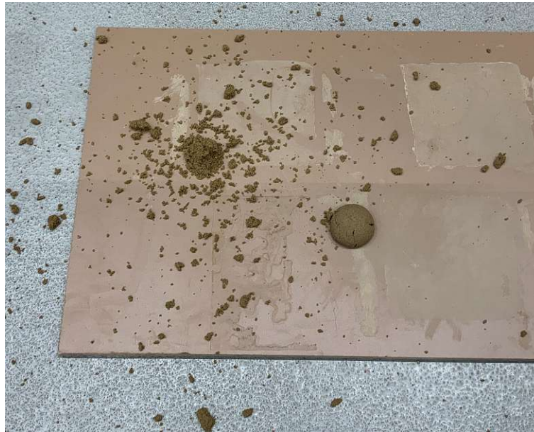
Abb. 4.7: Links: zu magere Mischung (ohne TLP), rechts: richtige Mischung (5 Ma% TLP)
