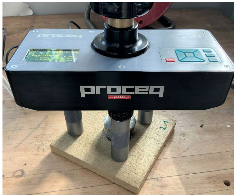
Abb. 4.19: Auf Probekörper 2.1 aufgesetztes Haftzugprüfgerät proceq dy-216
