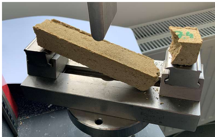
Abb. 5.18: Zerstörter Probekörper mit 5 Ma% Kasein mit Biegeversagen durch Materialinhomogenitäten beim Dreipunkt-Biegeversuch
