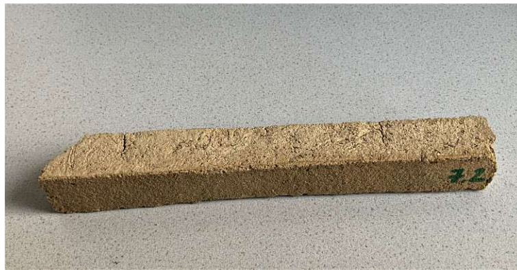
Abb. 5.17: Probekörper mit 5 Ma% Kasein mit erkennbaren Rissen vor der Biegezugfestigkeitsprüfung
