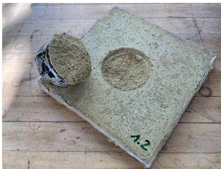
Abb. 5.8: Zerstörter Probekörper M1.2 nach der Haftzugfestigkeitsprüfung
