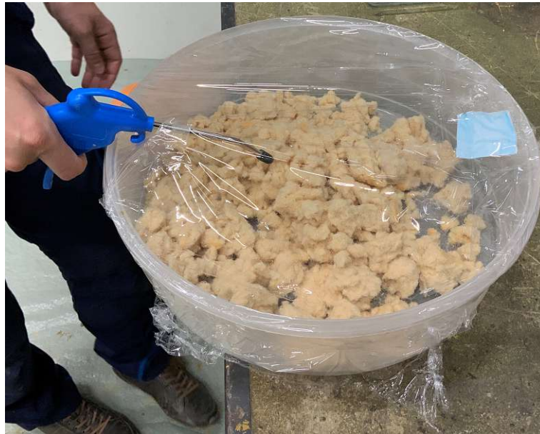
Abb. 4.4: Verklumpte Holzfasern nach Entnahme aus Liefergebinde
