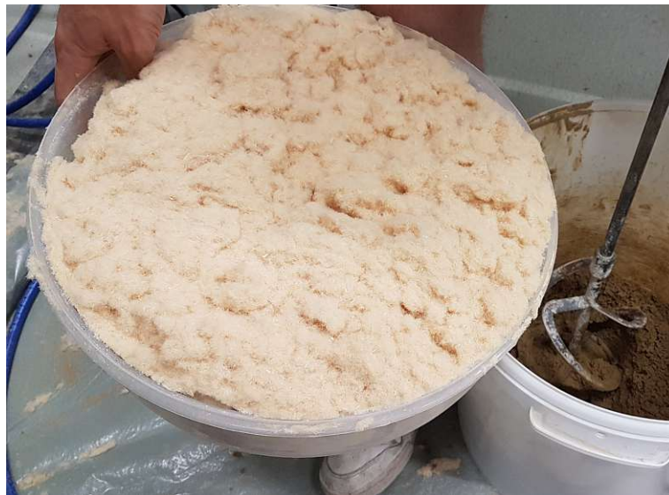
Abb. 4.5: Holzfasern, durch Druckluft von Verfilzungen gelöst, vor der Einmischung in Lehm- masse
