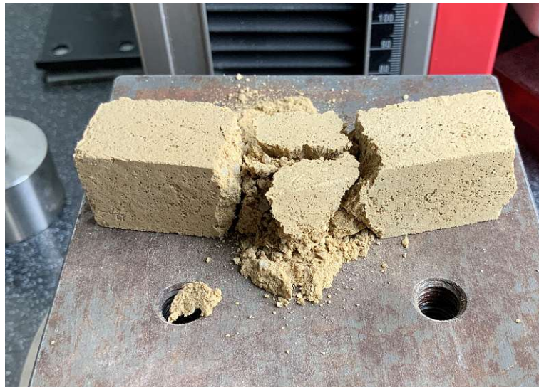
Abb. 5.7: Zerstörte Teilprobe M1.1 nach der Druckfestigkeitsprüfung
