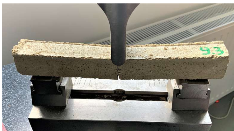
Abb. 5.21: Zerstörter Probekörper mit 4 Ma% gelöschtem Kalk nach dem Dreipunkt-Biegeversuch
