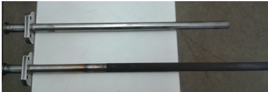
Abbildung 22: Vergleich kurzes zu langem Brennstoffzugaberohr mit Gebrauchsspuren.
