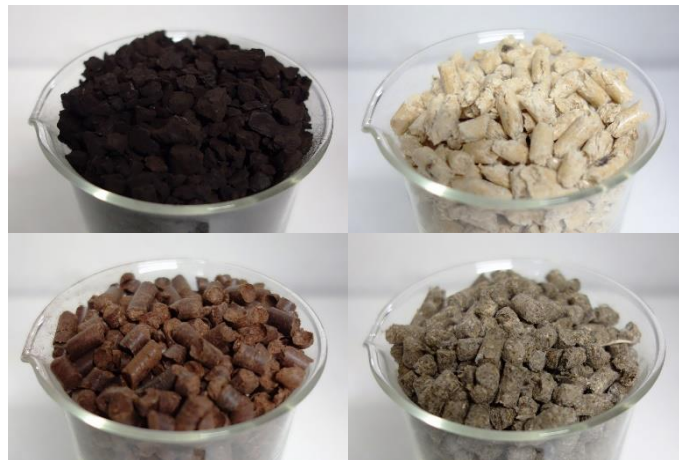
Abbildung 4-4: Untersuchte Brennstoffe (v. li. oben): Braunkohlebruch, Holzpellets, Rindenpellets und Hühnermistpellets
