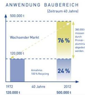
(b) Primär aluminiumbedarf der Baubranche 2012 bei einer Recyclingquote von 100 % (Bildquelle: [17])
