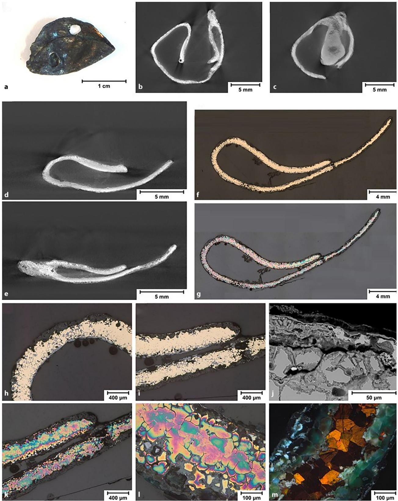
Abb. 9: Inz-4. a 3D-DM Aufnahmen, b–e mikro-CT Schnitte, f, h, i polierte Oberfläche, LOM, j REM, g, k, l, m Klemm 2 Ätzung, LOM m polarisiertes Licht, LOM
