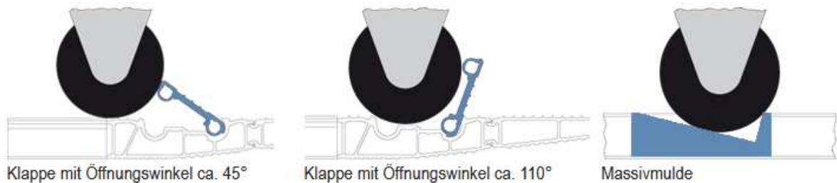
**Abbildung 38: Abrollsicherungsarten in der Plattformschleife<sup>79</sup>**
