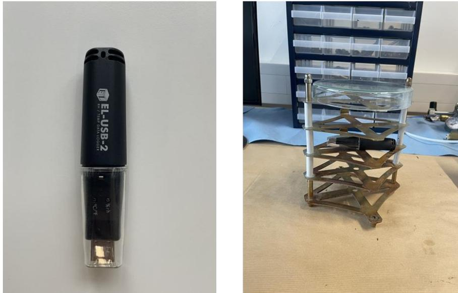
Abb. 29: EL-USB-2 Datenlogger (links) und Lagerung des Feuchtigkeitssensors im Stativ (rechts)
