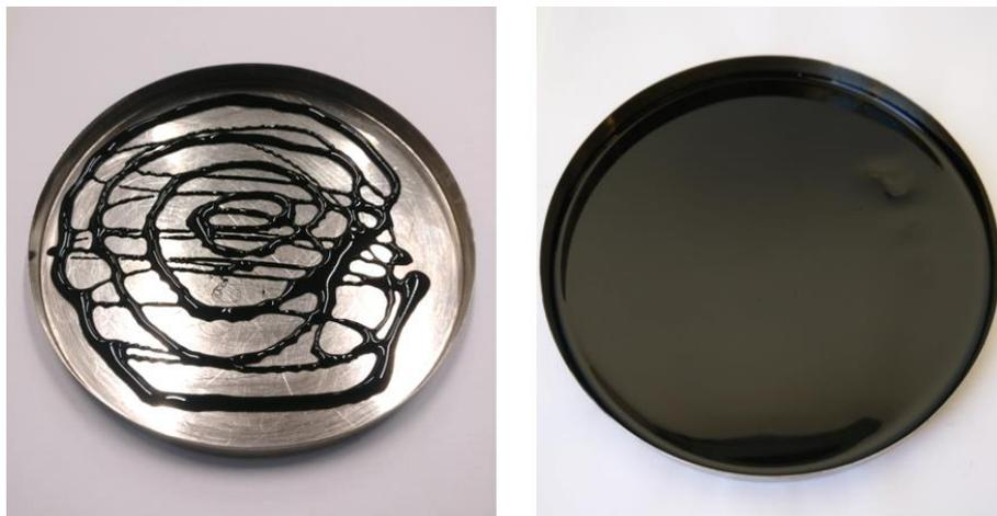
Abb. 28: Probenvorbereitung PreVBA (links) und Bitumenprobe nach Schwenkvorgang (rechts) [31]
