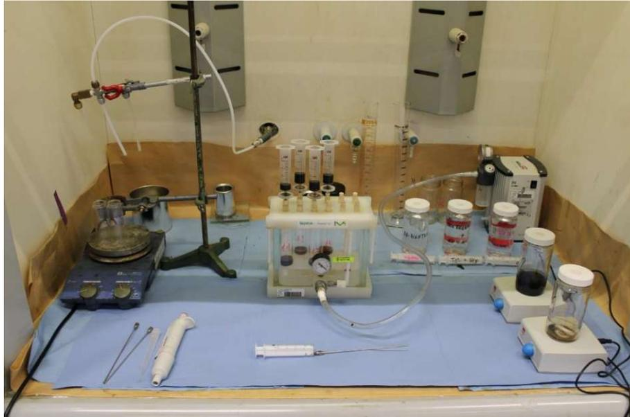
Abb. 26: Setup SARA-Fraktionierung
