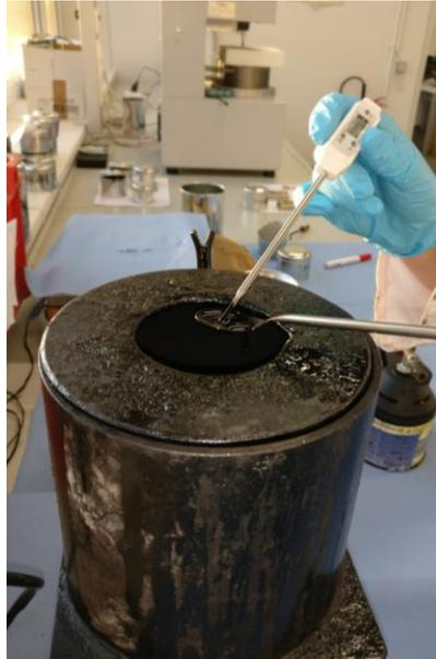
Abb. 22: Erwärmung einer Bitumenprobe mit Überwachung eines Stabthermometers [31]
