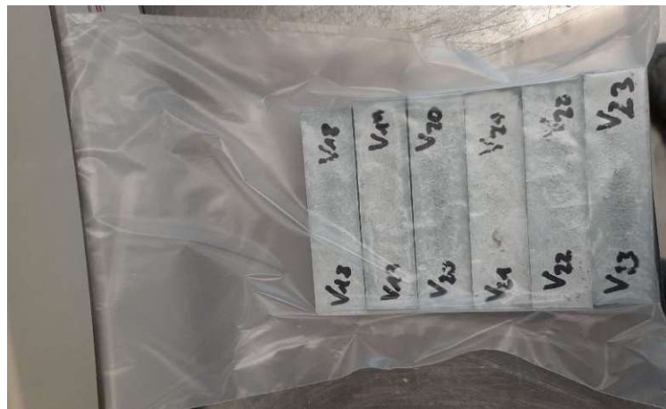
Abb. 2.10: „Vakuum“- Lagerung mit sicherlich nicht komplett geschlossenen Behältern
