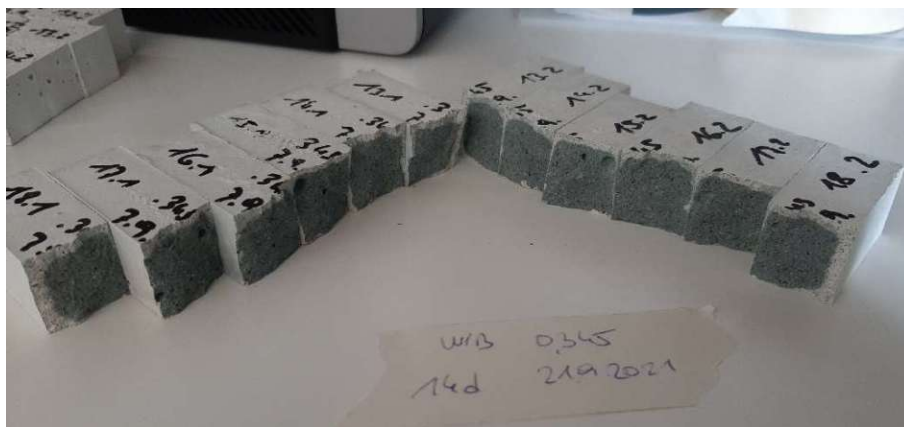
Abb. 3.10: Biegezugfestigkeitsversuch nach vierzehn Tagen
