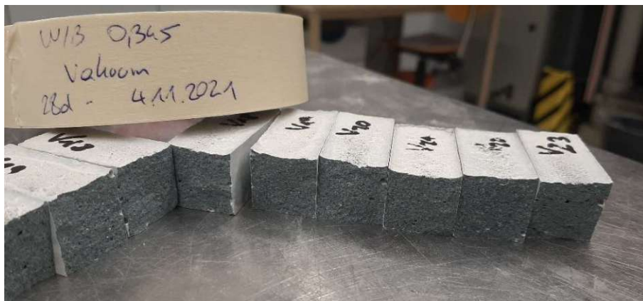
Abb. 3.16: „Vakuum“-Lagerung (nach 28 Tagen)
