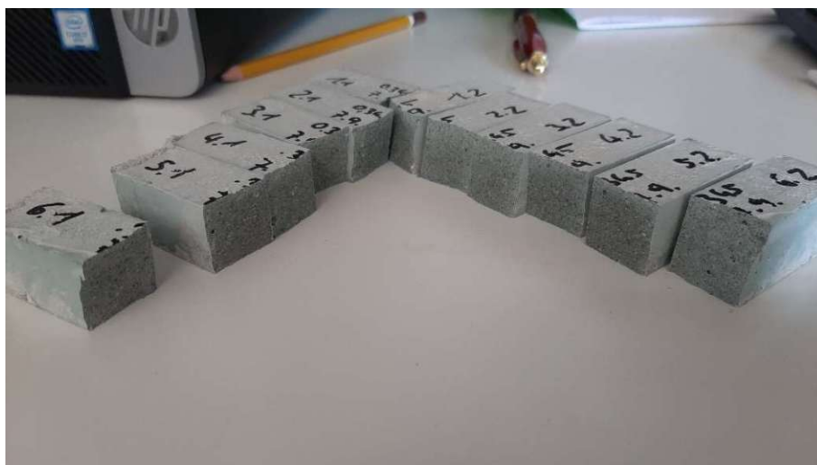
Abb. 3.8: Biegezugfestigkeitsversuch nach einem Tag
