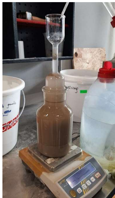
Abb. 2.3: Verwendung des Pyknometers für die Dichtebestimmung
