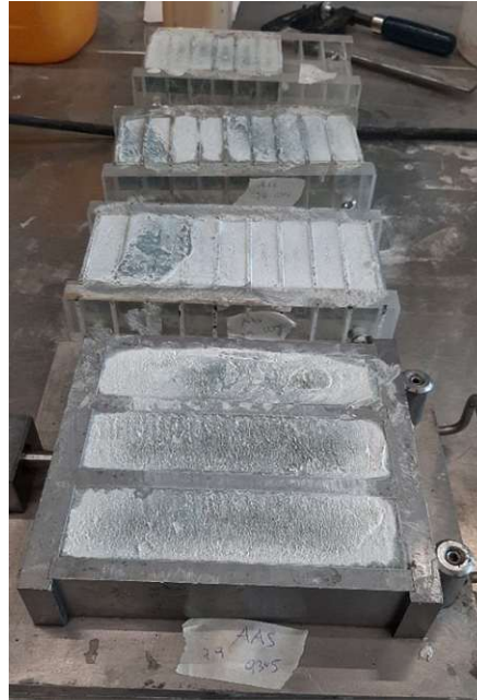
Abb. 3.5: Mischung mit W/B von 0,345 mit 50mM CaCl 2 und 0,9% PCE (nach einem Tag)
