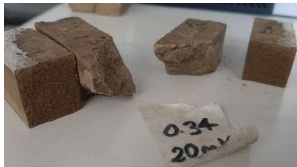
Abb. 7.7: Ausschalen mit anschließendem Bruch des Probekörpers
