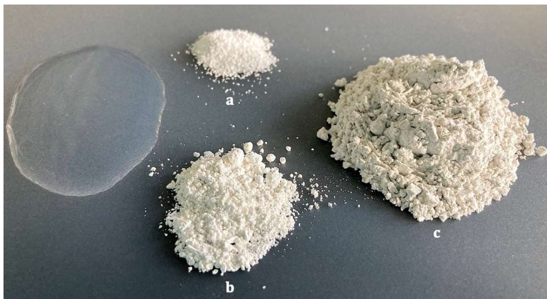
Abb. 2.1: Bestandteile unseres AABs: a) Na 2 CO 3 b) Slag c) Ca(OH) 2 76
