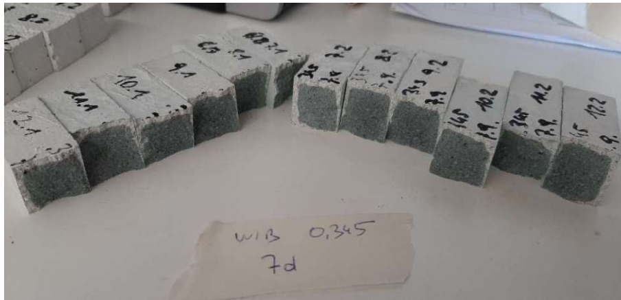
Abb. 3.9: Biegezugfestigkeitsversuch nach sieben Tagen
