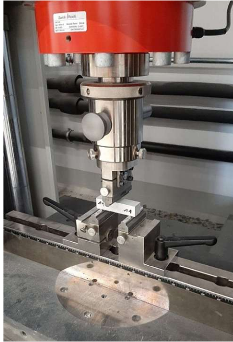
Abb. 2.11: Aufbau der „Zwick“-Maschine im Zuge der Biegezugfestigkeitsermittlung
