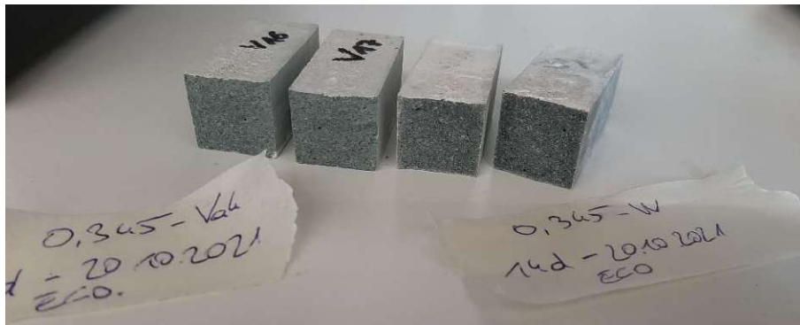
Abb. 3.14: Wasser/„Vakuum“-Lagerung (nach 14 Tagen)
