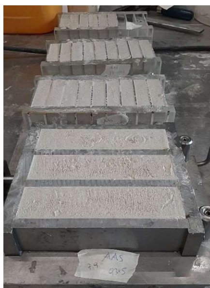
Abb. 3.4: Mischung mit W/B von 0,345 mit 50mM \text{CaCl}_2 und 0,9% PCE
