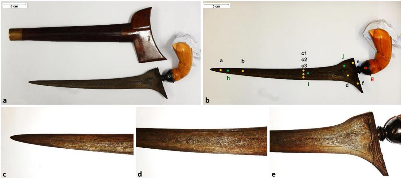
Abb. 3: Kris aus Privatbesitz **a** Kris mit Scheide, **b** Positionen an denen RFA-Messungen durchgeführt wurden (*gelb*– Vorderseite; *grün*– Rückseite; *rot*– Griffhalterung), **c, d** Detailaufnahmen der Klinge. Die Analysenwerte sind in den Tab. 2 und 3 zusammengestellt
