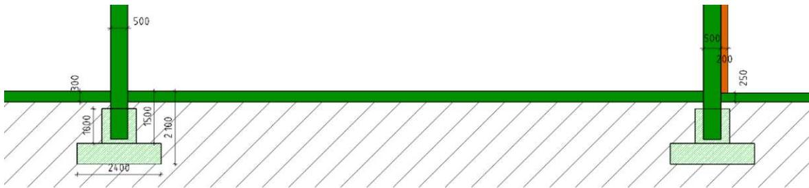
Abbildung 5-4 – Abmessungen der Bodenplatten und der Köcherfundamente
