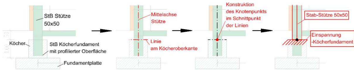
Abbildung 5-9 – unterer Stützen Knotenpunkt + Köcherfundament
