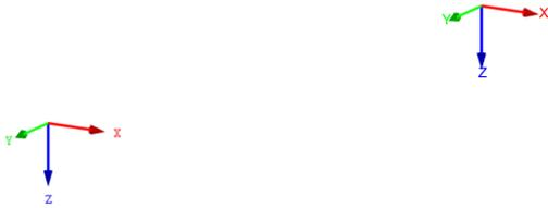
Abbildung 4-5 – Auswahl des globalen Koordinatensystems: z-Achse ist nach unten ausgerichtet
