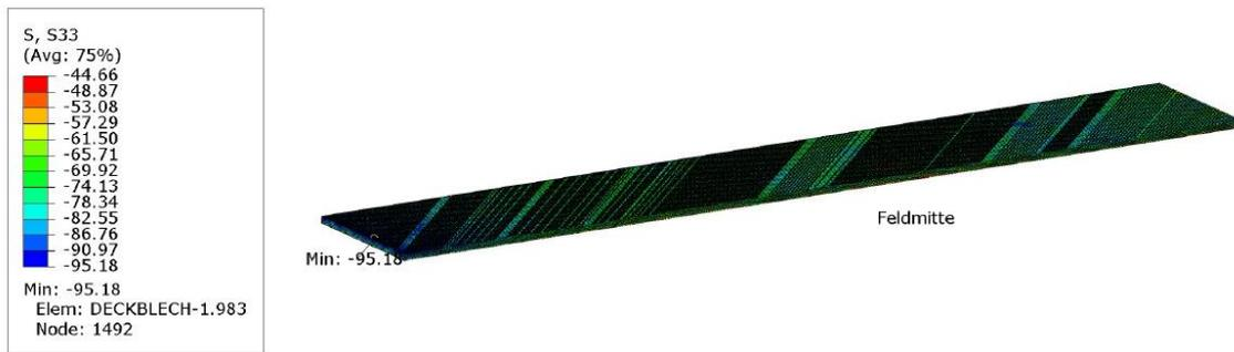
**Abbildung 7.25:** Maximale Druckspannung (95,18 N/mm<sup>2</sup>) im Deckblech des bewehrten Modells im ULS
