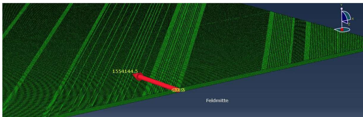
**Abbildung 5.14:** Normalkraft [N] im Deckblech in Feldmitte im FLS
