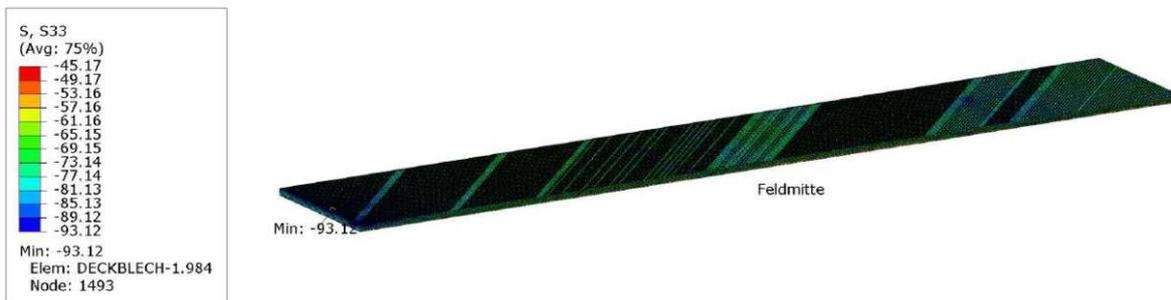
**Abbildung 7.24:** Maximale Druckspannung (93,12 N/mm<sup>2</sup>) im Deckblech des unbewehrten Modells im ULS
