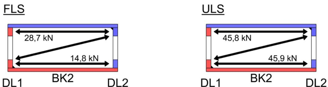
Abbildung 6.15: Kraft in den horizontalen Druckstreben in BK2; FLS - links, ULS - rechts
