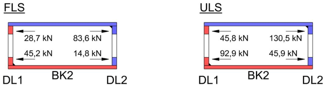
Abbildung 6.14: Kräfte in den Dübelleisten in BK2; FLS - links, ULS - rechts
