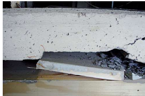
Abb. 2-29: Abscheren des Vorholzes
