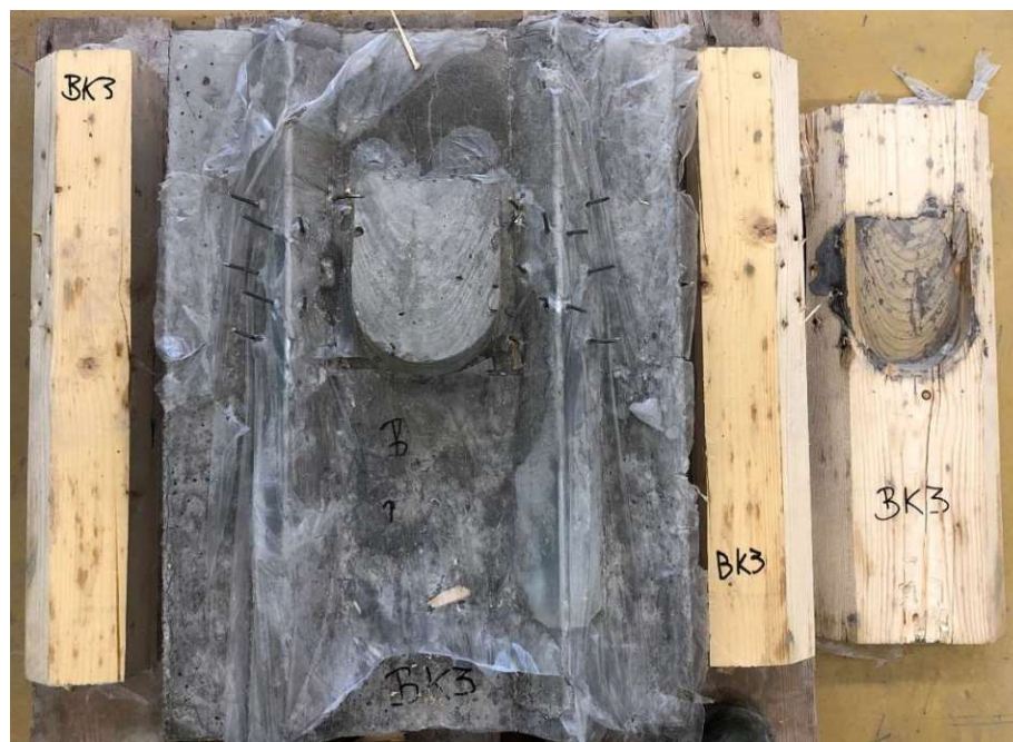
Abb. 3-25: typisches Versagensbild Blech+Kerbe intakte Kerbe
