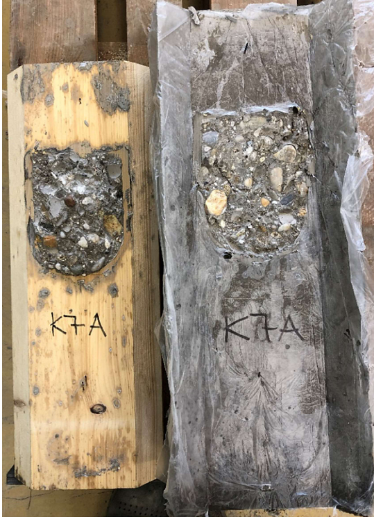
Abb. 3-17: typisches Versagensbild Kerve Versagen
