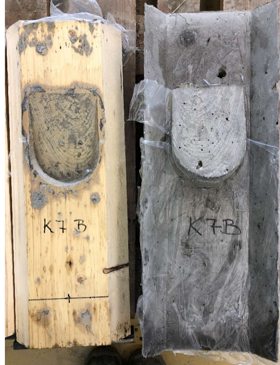
Abb. 3-18: typisches Versagensbild Kerve intakt
