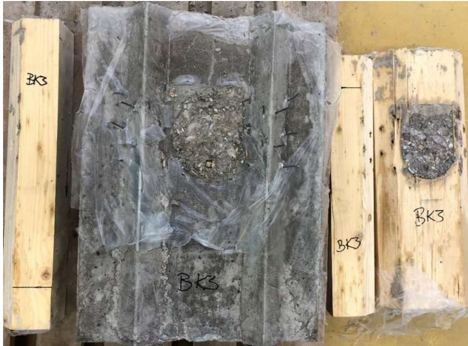
Abb. 3-24: typisches Versagensbild Blech+Kerbe Versagensseite
