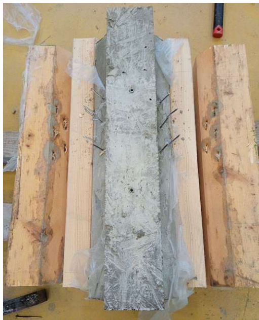
Abb. 3-13: typisches Versagensbild an Probekörper „B4“
