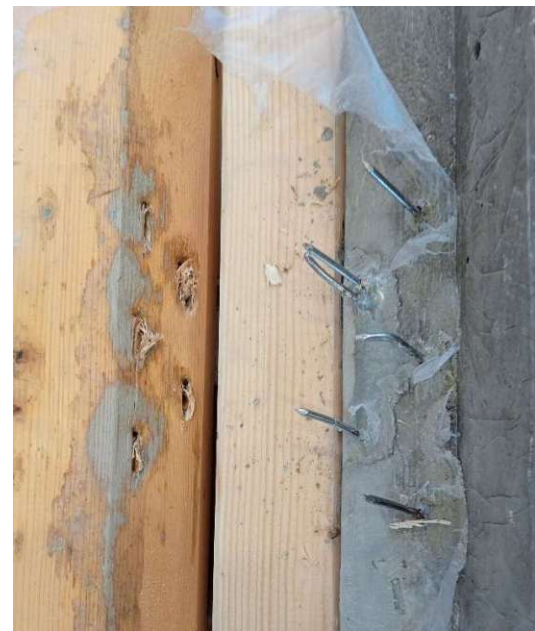
Abb. 3-14: Versagensmuster Versuchsreihe „B4“
