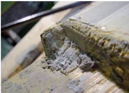
Abb. 2-28: Druckversagen des Holzes
