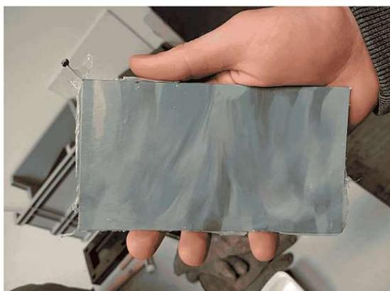
(a) Heißgepresste Probenplatte
