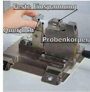
(b) Aufspannsystem für Schlagzugversuch [47]
