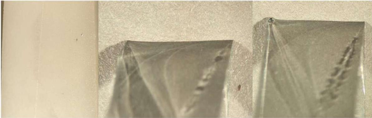
Abbildung 2-7: CHTT, links: gebrochenes Messer hinterließ Riefen in Oberfläche, mittig: Trimmmesser, rechts: Abtragsmesser
