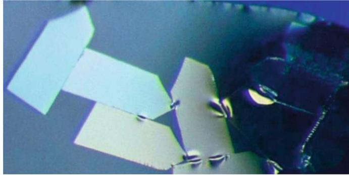
Abbildung 2-32: Trimmform ersichtlich bei aufschwimmenden Schnitten in Wanne
