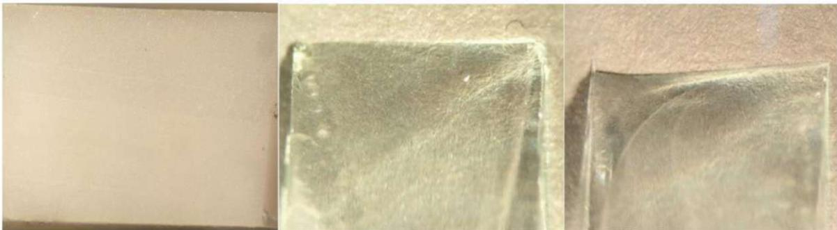
Abbildung 2-8: 10ETTMP, links: leichte Marken in Oberfläche, mittig: Trimmmesser, rechts: Abtragsmesser
