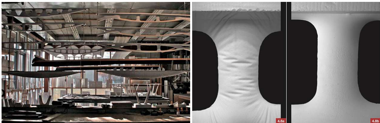
(a) Vielfalt der textil schalbaren Gebäude-Elemente, wie (b) Einfluss der Membranvorspannung auf die durch den gewichtsoptimierten Trägern oder verzweigten Stützen hydrostatischen Druck erzeugte Faltenbildung
