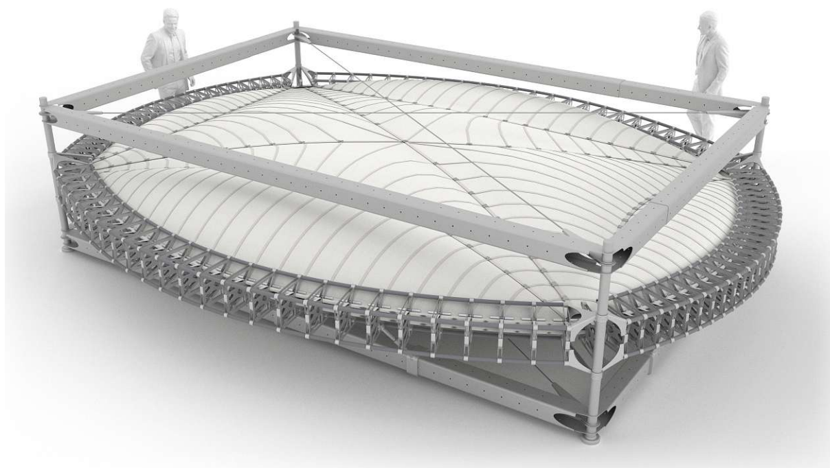
Abb. 4.2: V-Form Schalungssystem im pneumatisierten Zustand
