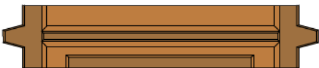
(Abb. 95.) Träger zum einhängen der Fassade-Riegel an der Attika und zum Aufstecken der Attika-Riegel
