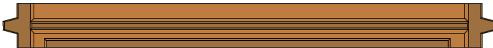
(Abb. 89.) Träger zum einhängen der Fassade-Riegel an der Attika und zum Aufstecken der Attika-Riegel
