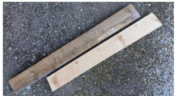
Abb. 110: Altholz und aufbereitetes Altholz
