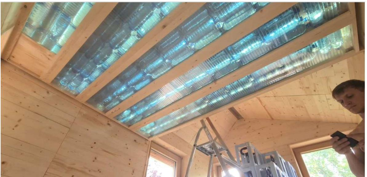
Abb. 195: Test der Speicherdecken-Hintergrundbeleuchtung
