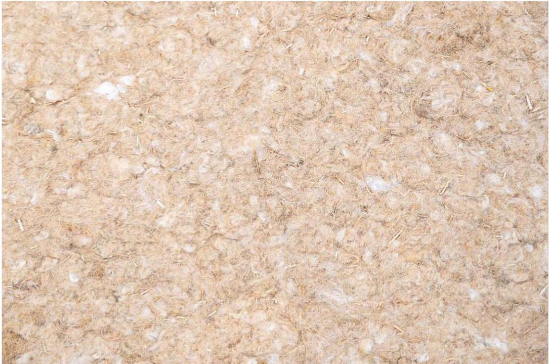
Abb. 29: Jutedämmung aus recycelten Kakaosäcken
