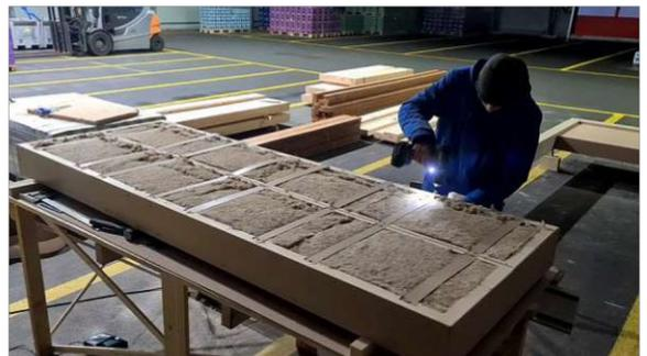
Abb. 82: Fixieren der Dämmung mittels Lattenrost
