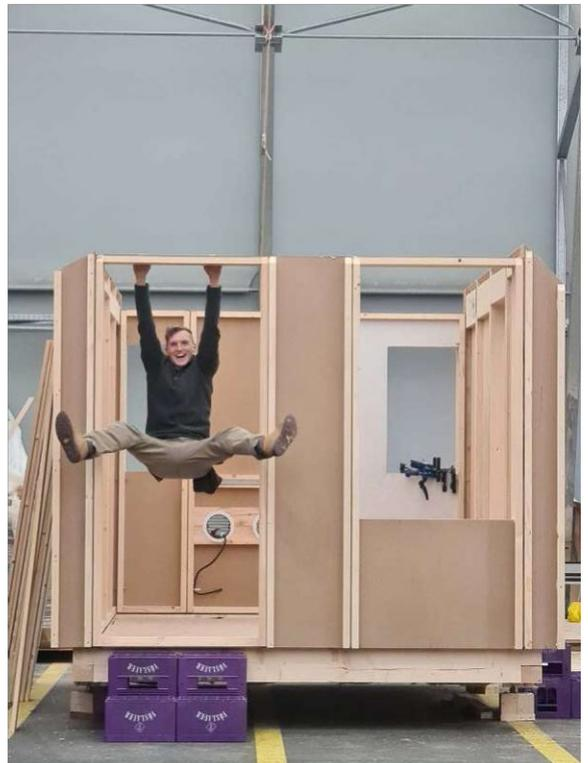
Abb. 102: Belastungstest des Türsturzes
