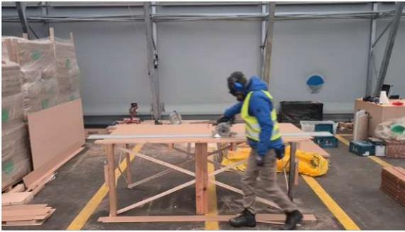
Abb. 77: Zuschnitt von Hartfaserplatten
