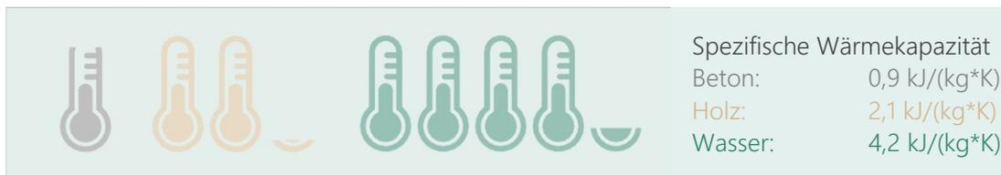
Abb. 2: Vergleich spezifischer Wärmekapazitäten
