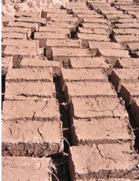
Abb. 29 - In der Sonne getrocknete Lehmziegel
