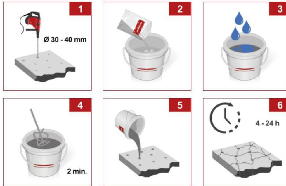
Abb. 26: Arbeitsablauf Betonamit
