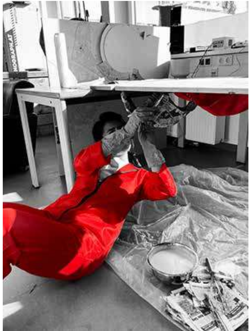
36 Aufkaschieren von Papier auf die erhärteten Tücher
