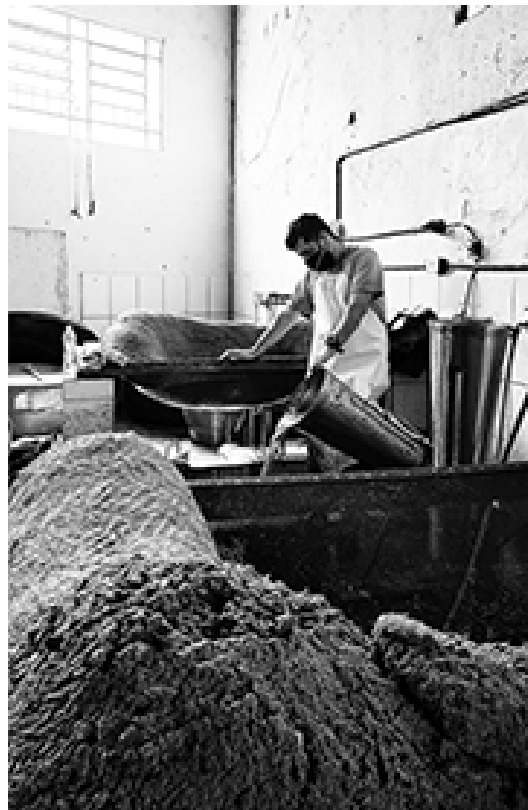
21 Herstellung der Papierpaste durch Einweichen und Zermahlen
