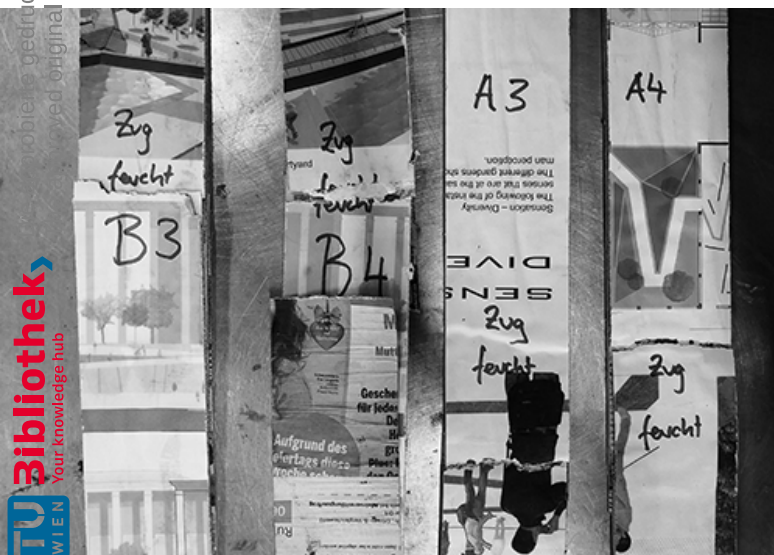
29 Rissverhalten nach Zugtest
