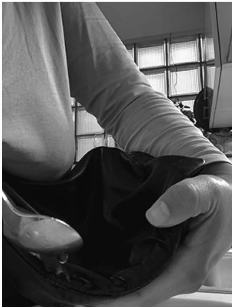
80 Auftragen von Paraffin an den Nahtstellen
