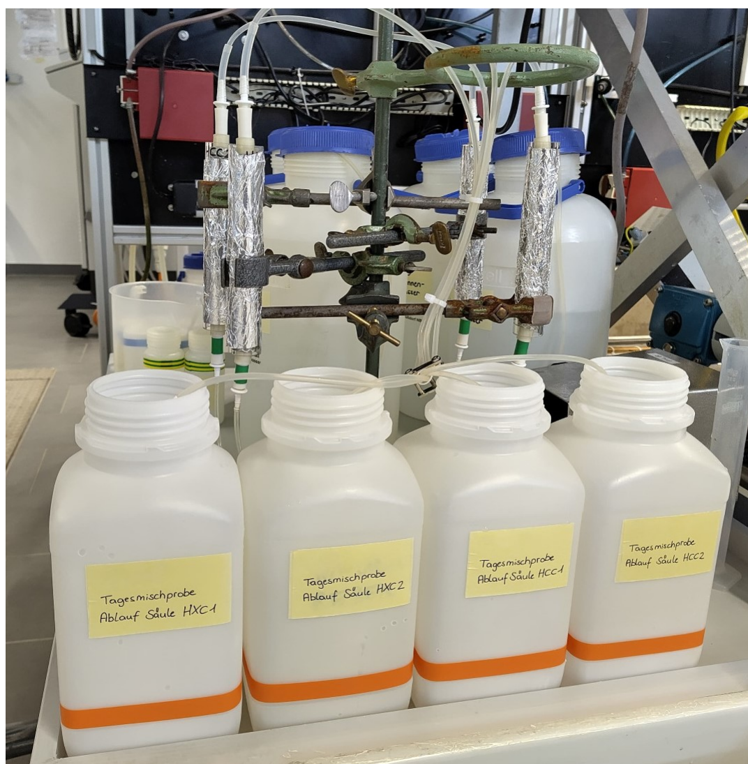
Abb. 4.6: Ansicht des gesamten Versuchsaufbaus der vier Filtersäulen während des Betriebs. Die Probenahme erfolgte über Nacht in Form von 18-Stunden-Mischproben. Der Zulauf stammt aus den 10L-Behältern mit blauem Deckel im Hintergrund. Quelle: Eigene Darstellung.
