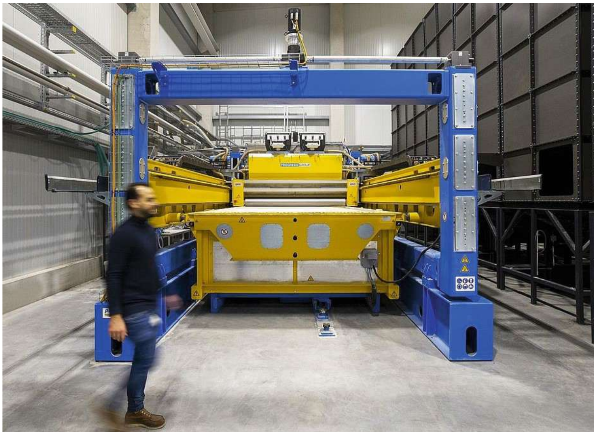
Abb. 4.8: SPI-Anlage der Progress 3D Innovation im Industriemaßstab mit 16 m 3 Bauraum (Quelle: Progress 3DI [65])
