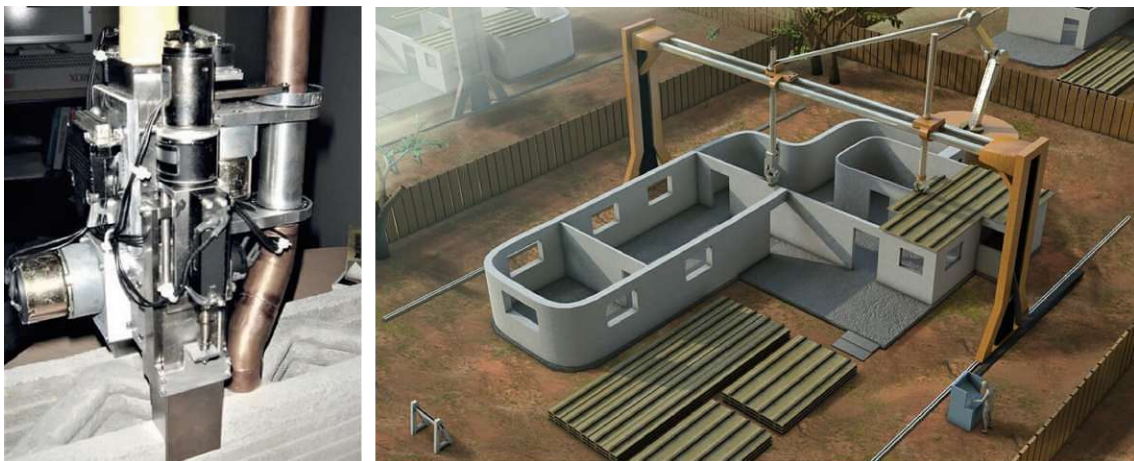
Abb. 3.12: Hybrid CC-Druckkopf extrudiert parallel drei Düsen (links), CC-Vision zukünftiger Bauprozesse (rechts) (Quelle: CC Corp [16])
