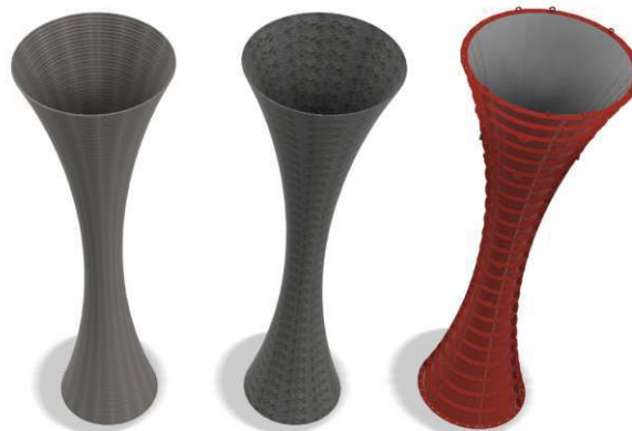
Abb. 5.1: Rendering der Vergleichsmodelle von additiv gefertigten verlorenen Schalungen nach dem 3DCP-Verfahren (links), dem SPI-Verfahren (mitte) und der wiederverwendbaren Schalung aus Stahl (rechts) (Quelle: Eigene Darstellung)
