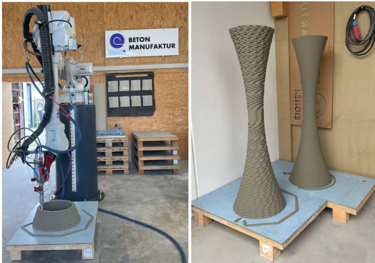
Abb. 4.17: Herstellungsdocumentation 3DCP-Verfahren in der Eigener Betonmanufaktur (Quelle: Eigene Aufnahmen)
