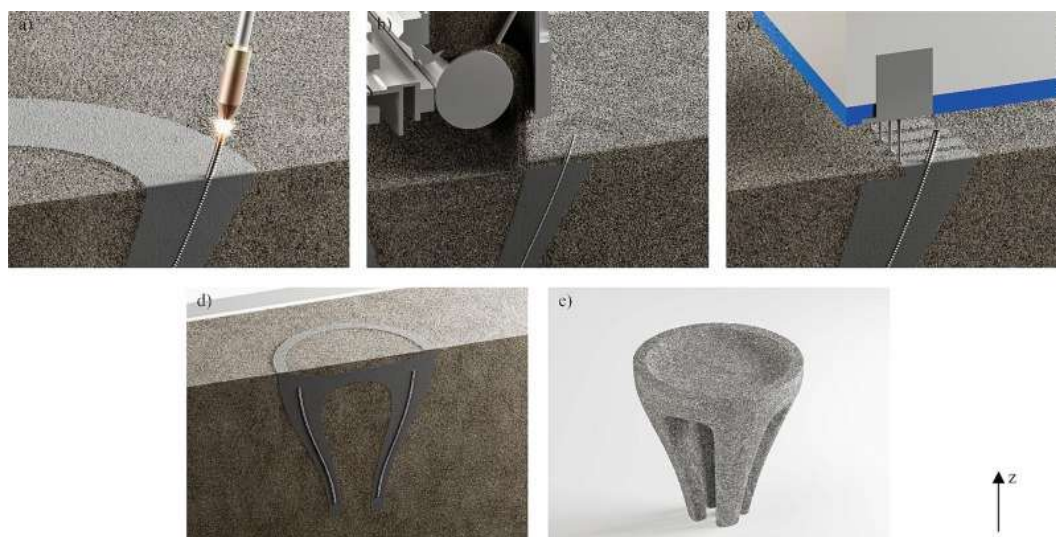
Abb. 6.1: Studie zu einem kombinierten Herstellungsprozess aus WAAM und SPI (Quelle: Straßer et al. [79])
