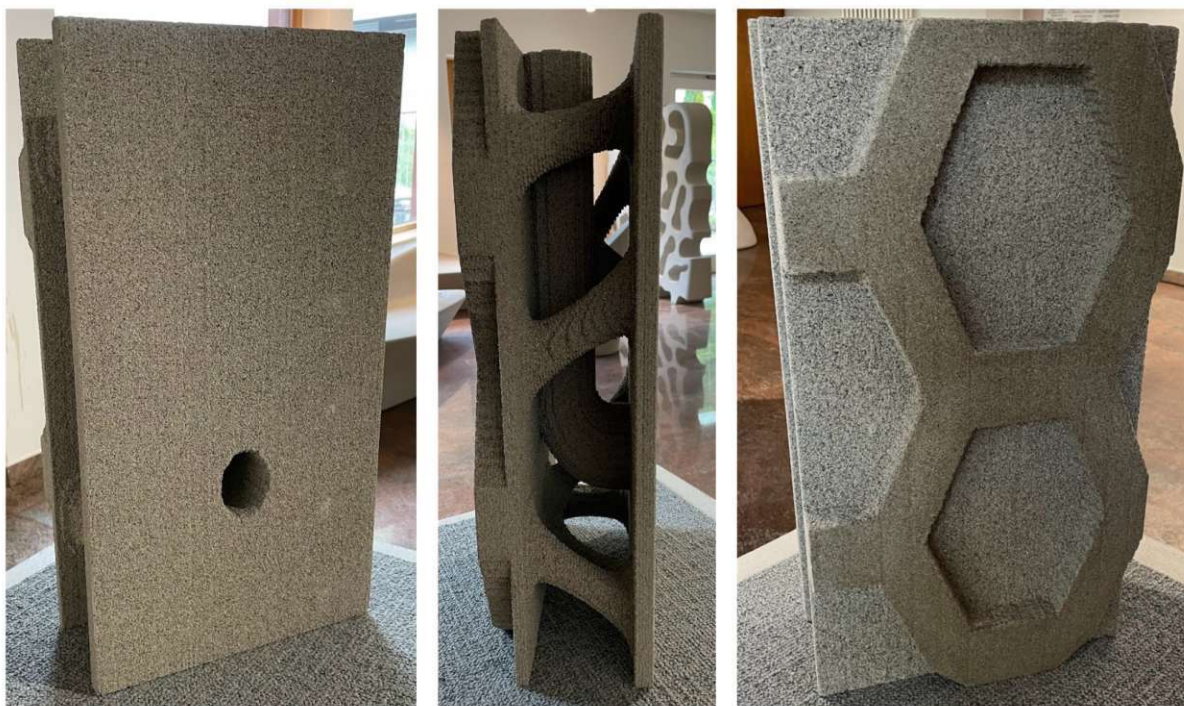
Abb. 5.5: Referenzbauteil Progress 3D Innovation - Integrale Doppelwand mit Außenfassade und Leitungskanal (Quelle: Eigene Aufnahmen)
