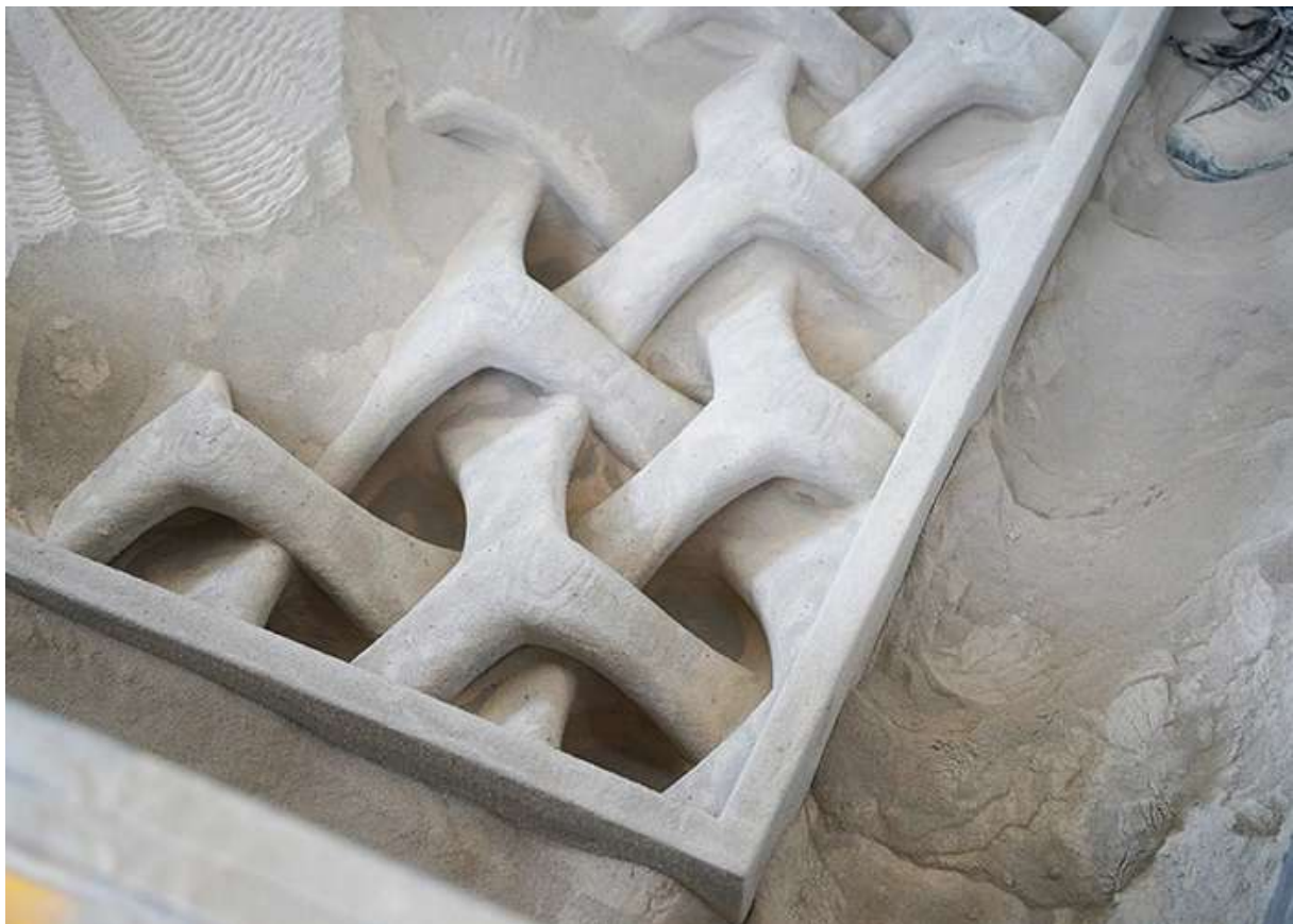
Abb. 4.9: Entpackungsvorgang eines nach dem additiven Verfahren SCA gedruckten Fassadenelements (Quelle: Frank [30])
