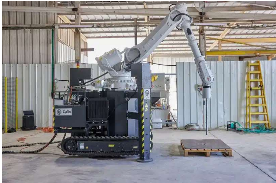
Abb. 3.8: Beton 3D-Drucker CyBe RC auf einer fahrbaren Raupenplattform (Quelle: Wakefield [93])
