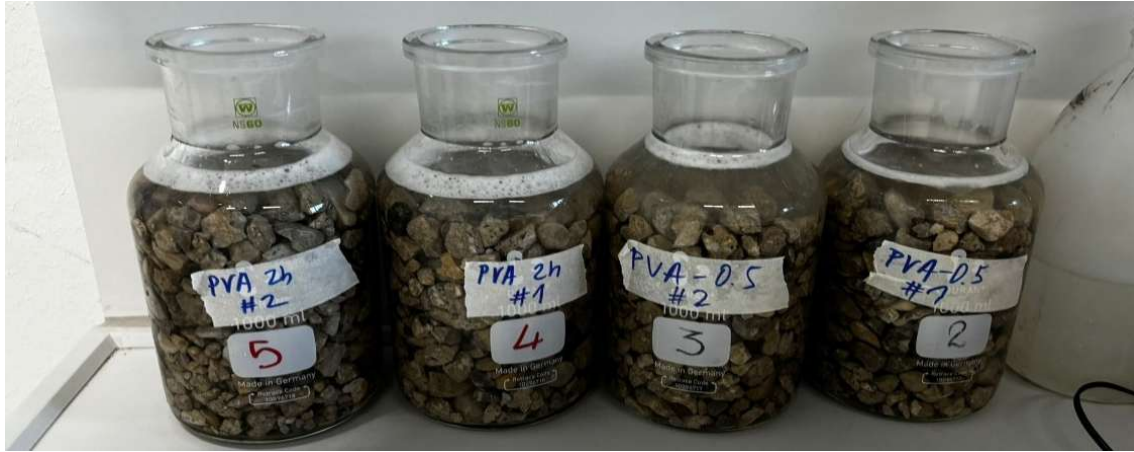
Abb. 22 Das Sinken der RG im Wasser über einen Zeitraum von 24 Stunden
