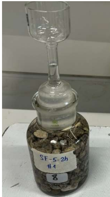
Abb. 23 Pyknometer mit RG bereit zum Wiegen
