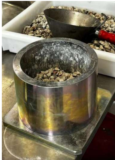
Abb. 18 Erstes Drittel des Zylinders mit RG gefüllt
