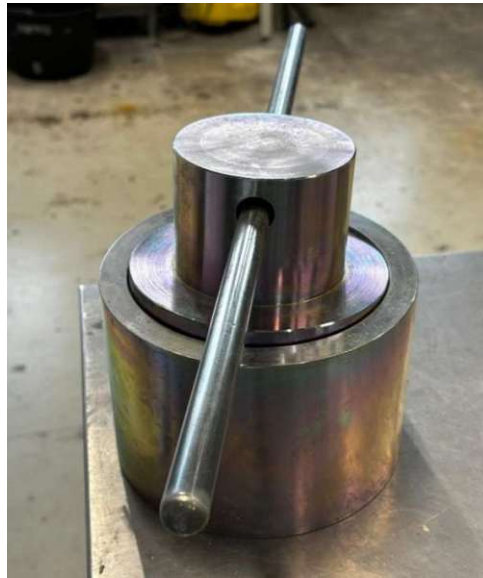
Abb. 19 Zylinder gefüllt mit der RG und bereit für Druckversuch
