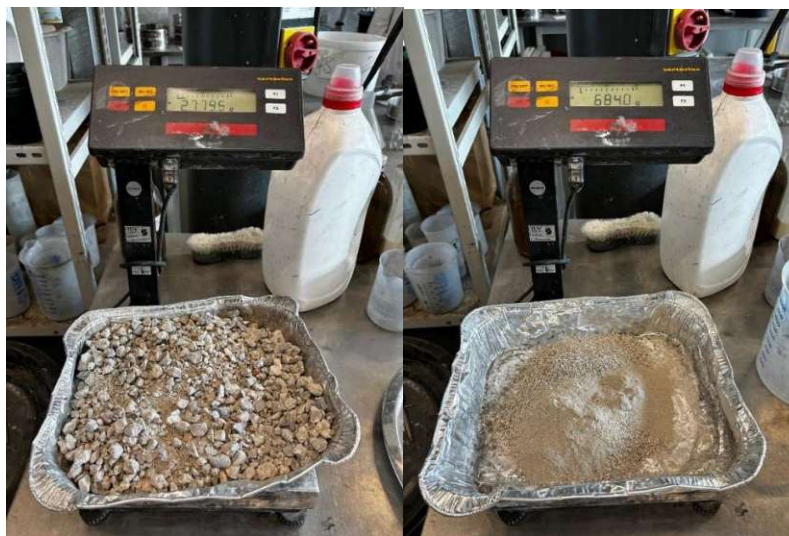
Abb. 20 Links Masse M_1 von RG nach dem Druckversuch und rechts Masse M_2 nach dem Sieben
