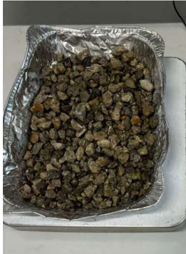
Abb. 24 Gesättigte, oberflächentrockene Gesteinskörnung
