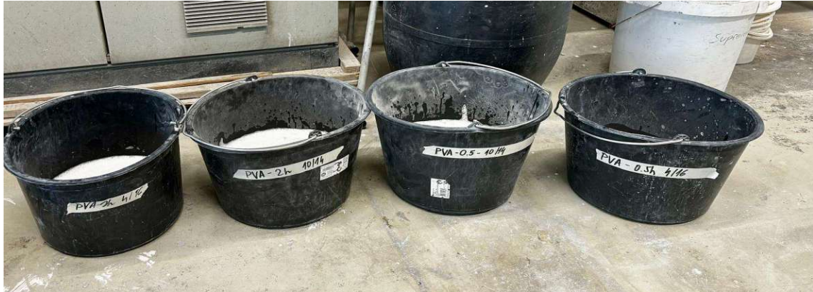
Abb. 15 Eintauchung von rezyklierten Gesteinskörnungen in Polymeremulsion
