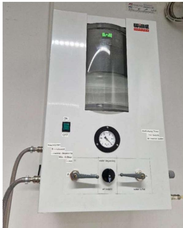
Abb. 3.12: Wasser Entgasungsanlage
