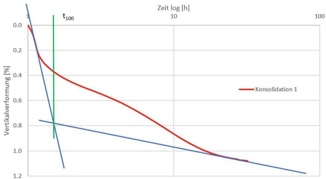
Abb. 4.27: beispielhafte Bestimmung der Primärkonsolidationszeit  $t_{100}$
