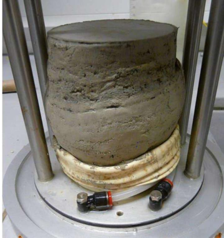
Abb. 4.3: Probekörper nach dem mehrstufigen Triaxialversuch [14]
