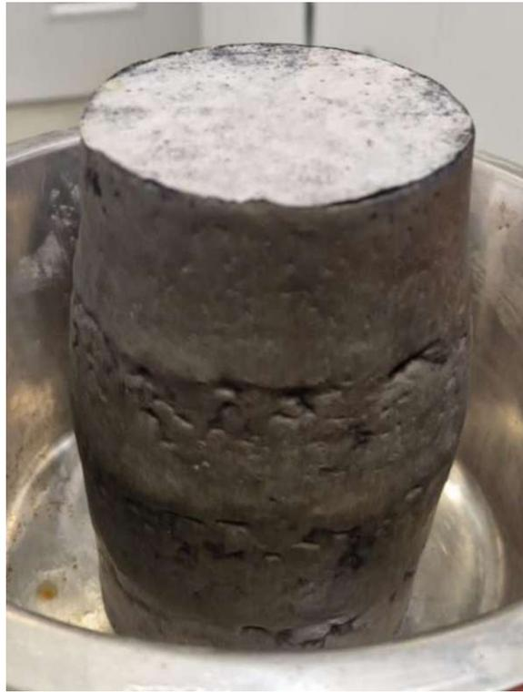
Abb. 6.6 Probekörper 998\_2\_MSTriax\_1 nach dem Ausbau aus der Triaxialzelle
