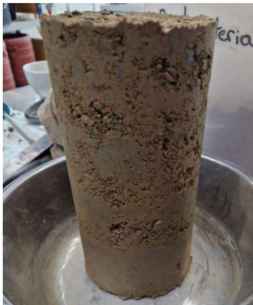
Abb. 6.10 Probekörper 998\_5\_MSTriax\_CID\_1 vor dem Versuch
