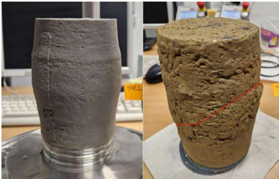
Abb. 3.19: Bruchformen von Triaxialversuchen; links: feinkörnige Probe mit Ausbauchung; rechts: gut gestufte grobkörnige Probe mit markanter Scherfuge
