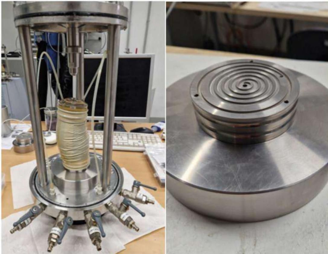
Abb. 3.10: links: Triaxial-Rahmen mit Probe nach dem Versuch; rechts: Sockel und Bodenaufsatz mit Drainagebohrungen
