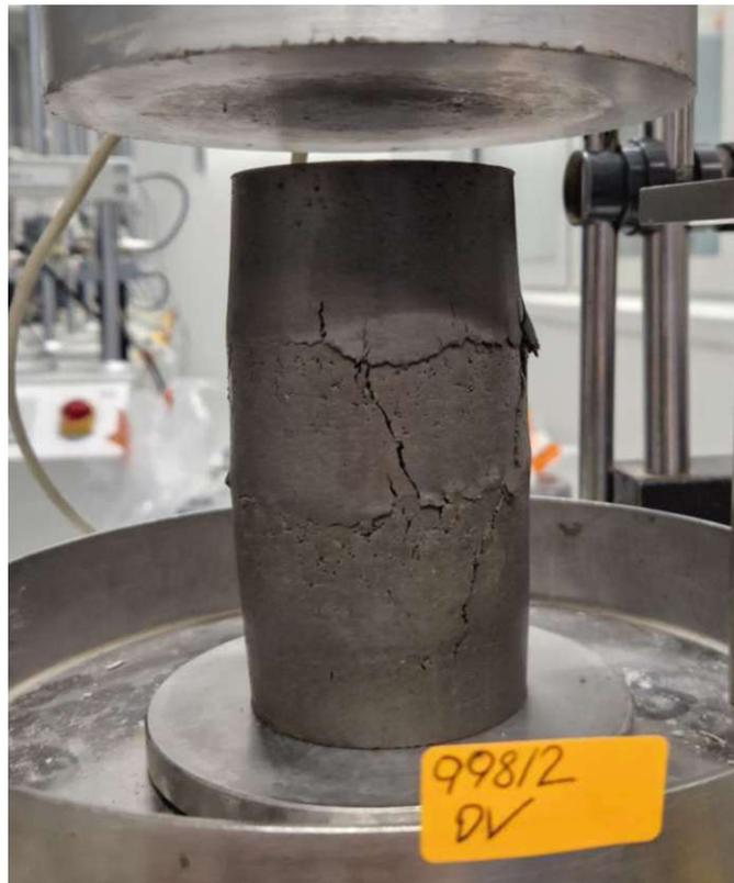
Abb. 5.10: Probekörper 998\_2 nach dem einaxialen Druckversuch
