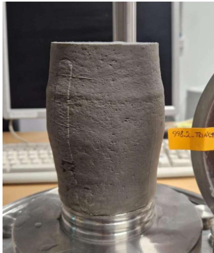
Abb. 6.3 Probekörper nach dem konventionellen Triaxialversuch 998\_2\_Triax\_1
