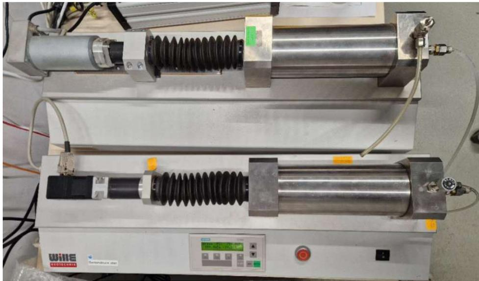
Abb. 3.9: Zeldruckerzeuger und Porenwasserdruckerzeuger
