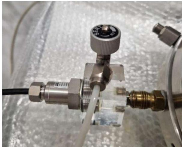
Abb. 3.15: externer Porendrucksensor
