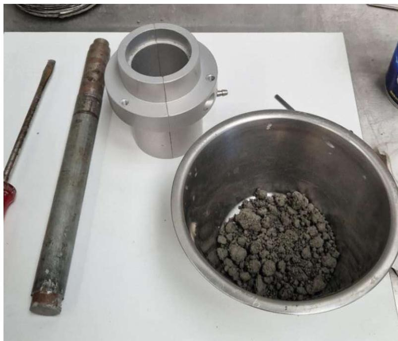
Abb. 6.23 Herstellung der Probekörper mit 40 mm Durchmesser mit Material 998\_2
